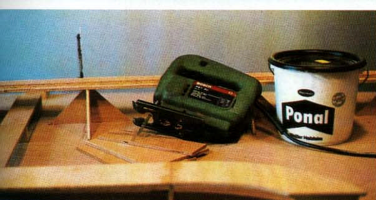
Foto 2. Es recomendable utilizar la sierra de calar para recortar, en los tableros de contrachapado de 6 mm de espesor, los trazados ferroviarios y de carretera. Foto T. Mauer.
