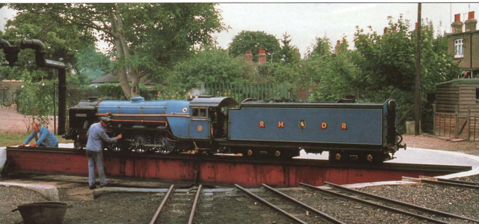
Figura 4: El operario hace girar la locomotora n° 8 "Hurricane" mediante una manivela operada manualmente en la estación de Hythe.
