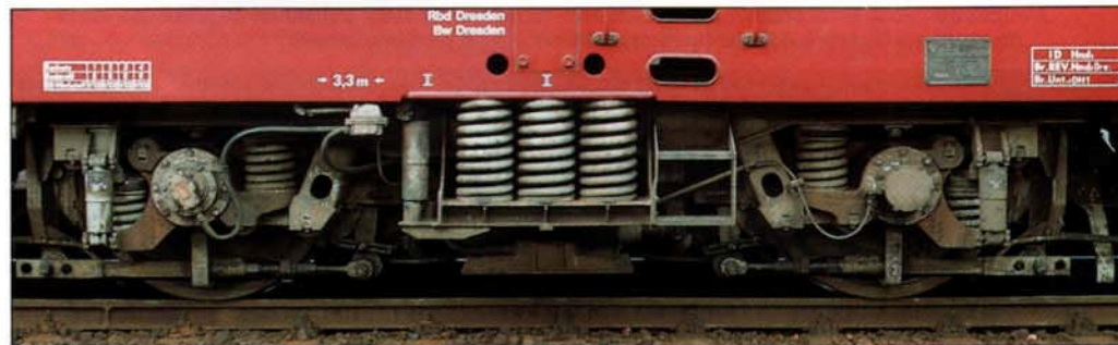
6 y 7 (abajo): También al comparar los bogies del original con los del modelo, la 143 de Roco causa una excelente impresión. Todos los detalles están reproducidos con total exactitud. Llama especialmente la atención el grupo de muelles en espiral. Fotos 1 y 3 a 7: MV/H. Scholz
