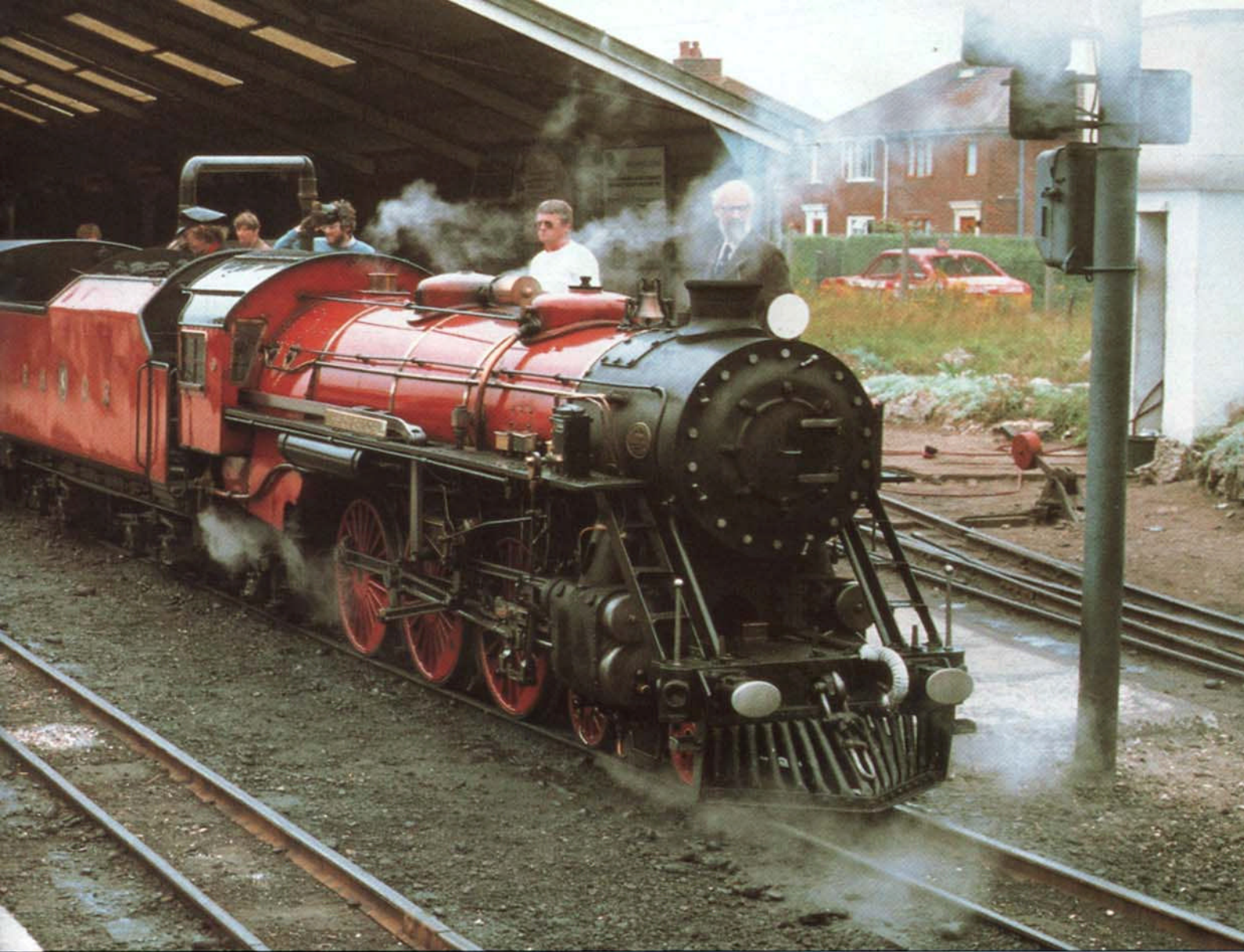
Figura 2: La locomotora n° 9 "Winston Churchill" va equipada con una defensa "Cow-catcher", aunque las posibilidades de encontrar ganado en el trayecto son muy remotas.
