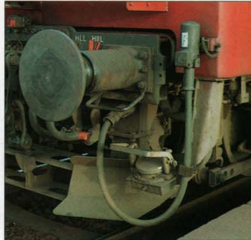
4 y 5: La conducción múltiple de trenes: aquí se reconoce la posición de las piezas 097 y 098.
