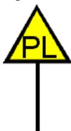
8.2.1.4. (53bis/2) I segnali di cui sopra possono anche proteggere più passaggi a livello (fino ad un massimo di tre) susseguentesi a distanza non superiori a quella di frenatura. In tali situazioni il segnale di protezione e quello di attenzione devono essere muniti di una vela inferiore aggiuntiva con l'indicazione, di tipo rifrangente, del numero dei passaggi a livello protetti.
