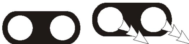
3.7.1.2. (51bis/1) Il segnale di «avanzamento» serve per autorizzare un treno a superare un segnale di protezione, di partenza interno o ripetitore di partenza, disposto a via impedita o
