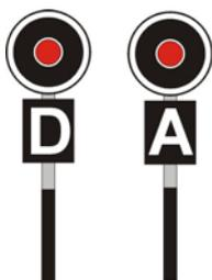
3.8.2.2. (48ter/2) I segnali di blocco delle località di servizio (partenza di stazione, protezione dei bivi, ecc.) poste sulle linee esercitate con blocco elettrico conta-assi o manuale, possono essere muniti di una tabella rettangolare a fondo nero, applicata sullo stante del segnale, recante la lettera maiuscola luminosa “A”.
