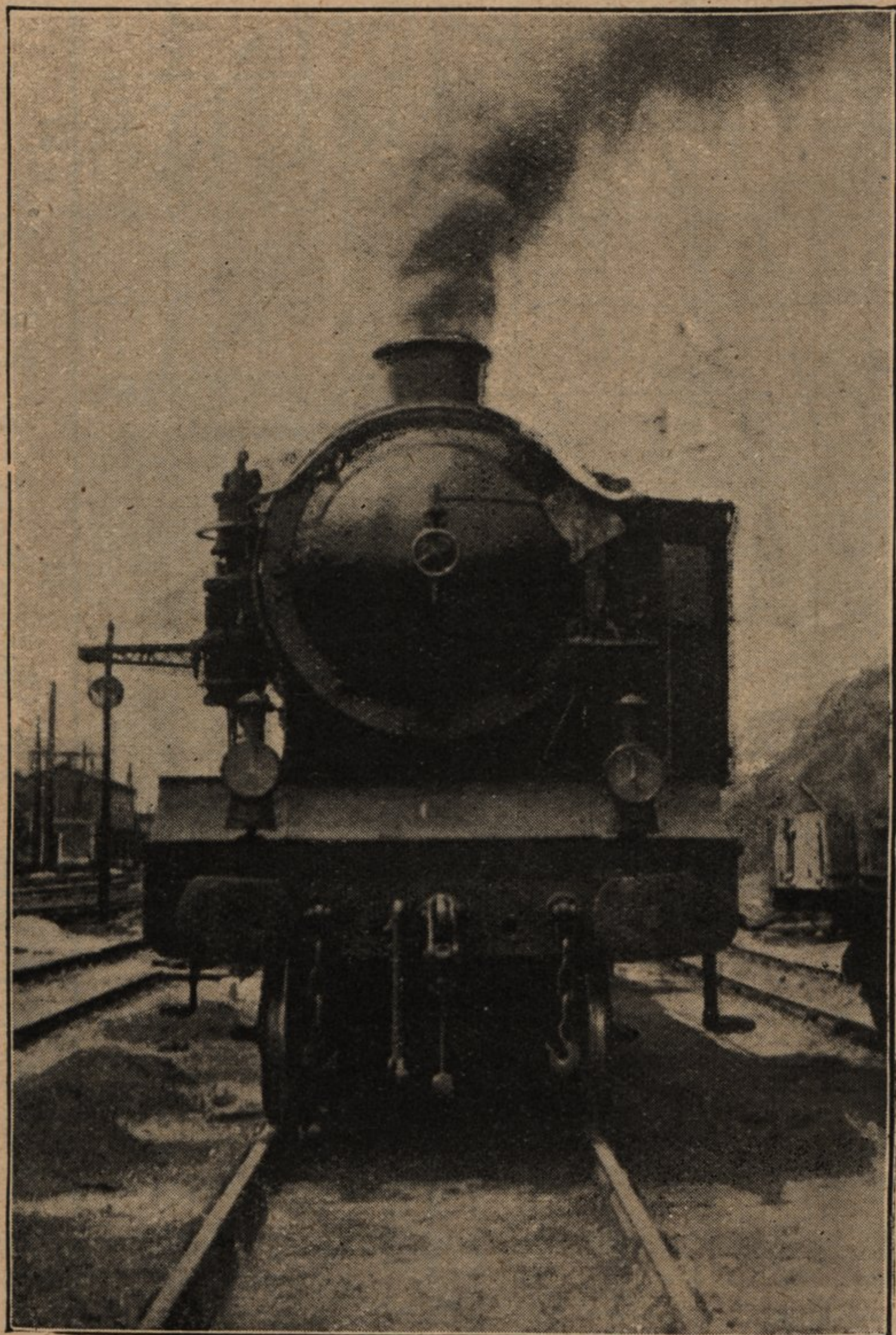
Fig. 37. — MACHINE COMPOUND 4 CYLINDRES A VAPEUR SATURÉE. SUR LE CÔTÉ : CABINE A EXPÉRIENCES.
