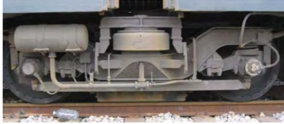
*Bogie portante UTA, ejemplo de bogie remolcado*
