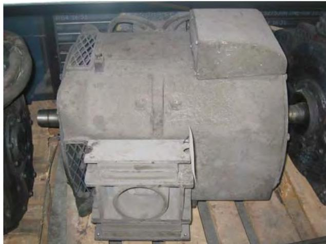
*Motor de tracción de B&W*
