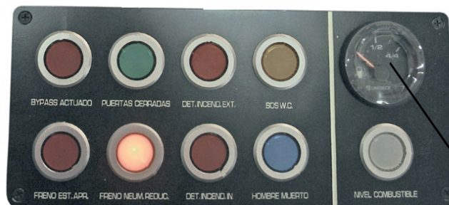
Indicador de combustible (coches M1y M2) depósito gasoil
