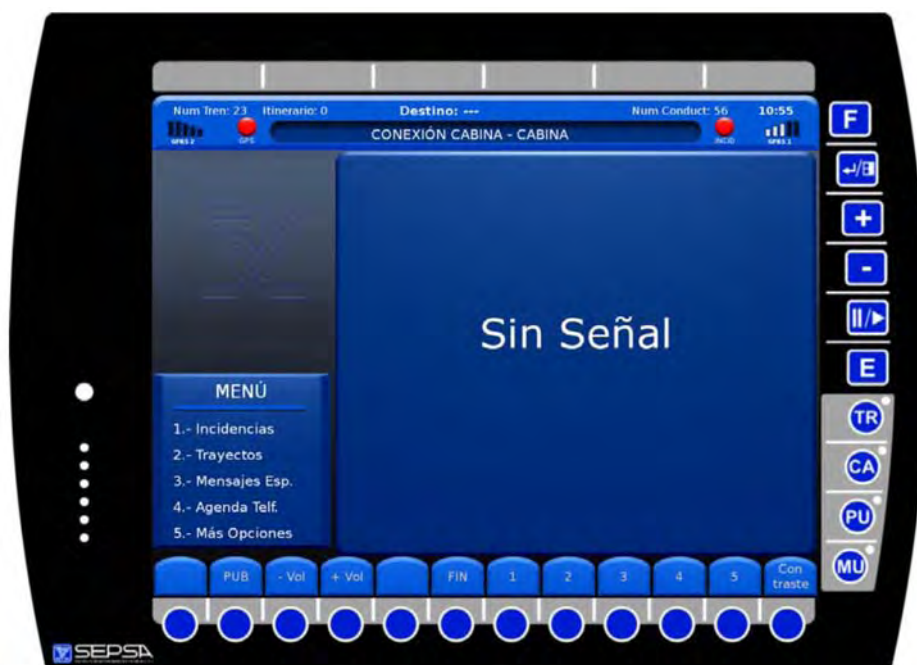
Figura 3-14 TC: pantalla principal con la conexión Cabina-Cabina
