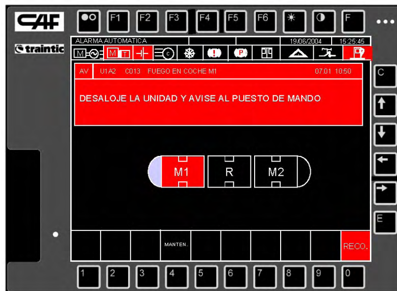
Figura 4-17. Pantalla ALARMA-AUTOMÁTICA ALTA IMPORTANCIA
