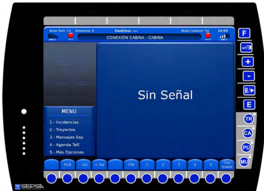
Figura 6-4. Pantalla principal con la conexión Cabina-Cabina
