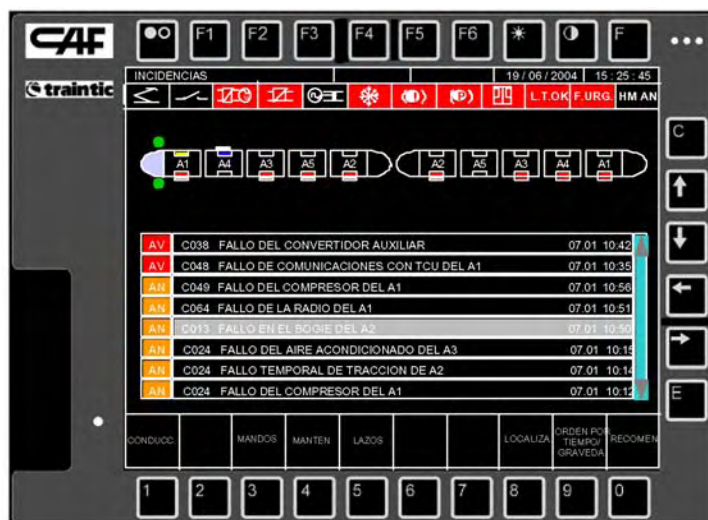
Figura 4-13. Pantalla INCIDENCIAS: composición de 2 UTs acopladas
