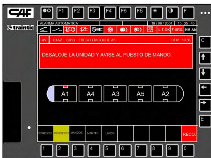
Figura 4-18. Pantalla ALARMA-AUTOMÁTICA de fuego
