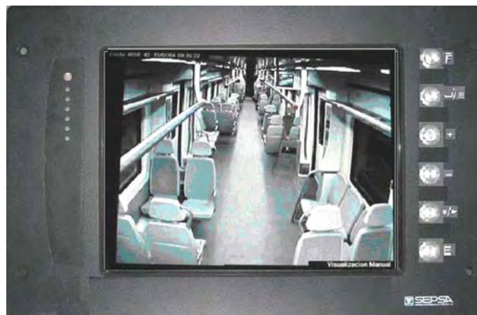
Figura 2-12. Terminal de cabina SIV/SVE/SVV
