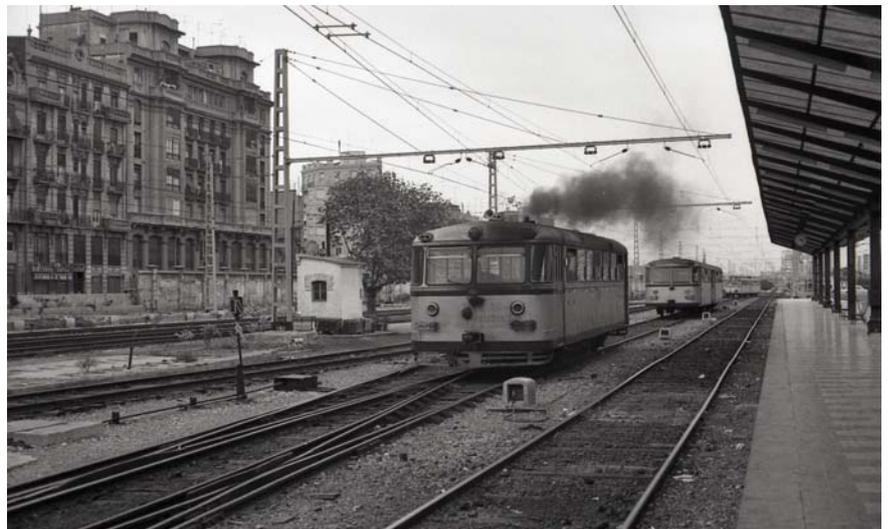
El ferrobús 301 «El Abuelo» realizando las maniobras para colocar en cabeza el coche motor. Este prototipo de tres unidades solamente tenía un coche motor siendo necesaria la maniobra para colocarlo en cabeza del tren. Valencia-Término 1 de noviembre de 1975. Foto Jaime Roca.
