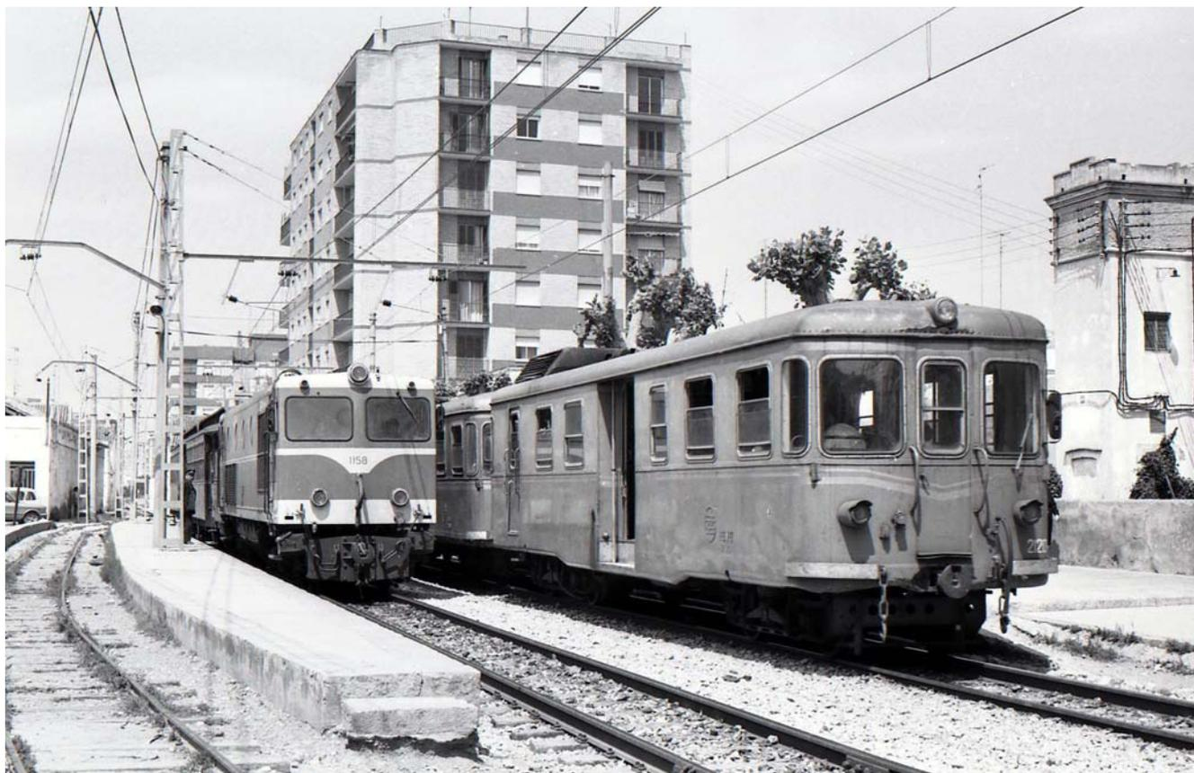
Durante las obras de renovación de catenaria entre Valencia y Rafelbuñol se utilizó material Diesel para no interrumpir el tráfico en esta línea y poder trabajar a buen ritmo. La locomotora Diesel-hidráulica 1158 con una composición de «portugueses» cruzando con los automotores Billard 2120 y 2101 en Massamagrell. Mayo de 1986. Foto Enrique Andrés.
