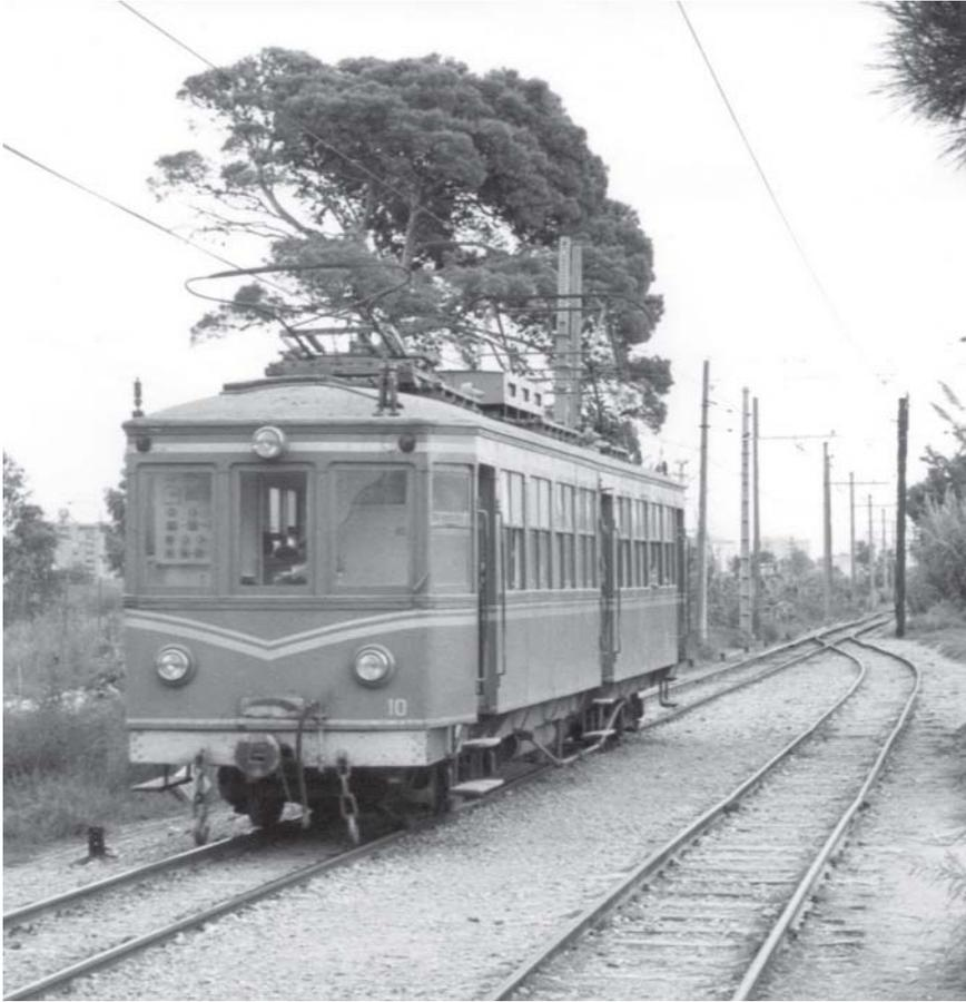
El automotor 10 saliendo de La Carrasca donde actualmente se encuentra una entrada de la Universidad Politécnica. Este automotor se libró de la reforma pero no de la metalización y pintado en colores corporativos de Feve. Se observa el lamentable estado de la vía y el sistema funicular para el movimiento de agujas que la línea conservó hasta el final de sus días. Año 1979. Foto Enrique Andrés.
