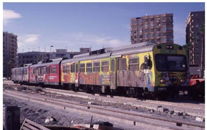
El automotor MAN 3007/3001/3012, en sus últimos meses de servicio y con un aspecto bastante degradado, circula muy lentamente a su paso por las obras de construcción de la nueva estación de Creueta. En dicha dependencia se ha instalado vía en placa con bloques aligerantes que se sitúan junto al carril tipo garganta para disminuir la cantidad de elastómero a emplear. El servicio que presta el automotor es El Campello-Denia. 25 de diciembre de 2005. Foto José Marcos Ortega Álvarez.
