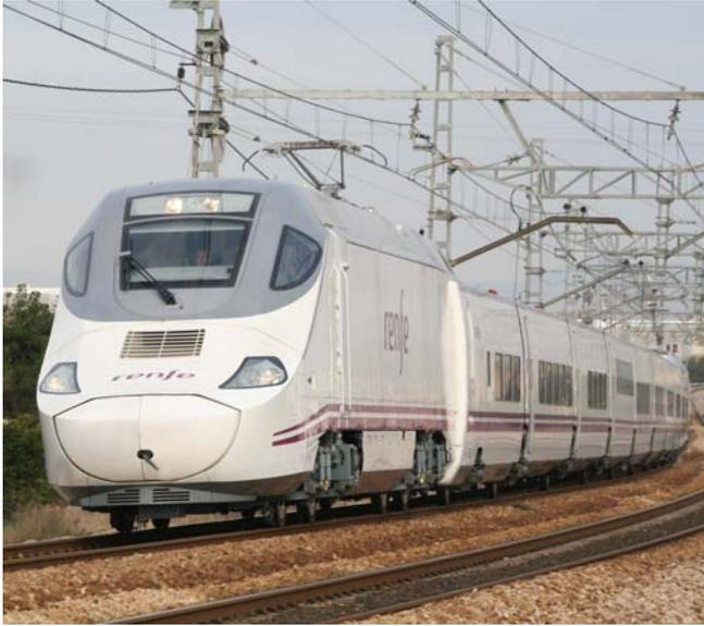
**Pruebas del Talgo Serie 130.** Durante 2006 y 2007 se han desarrollado pruebas de homologación en el tramo de Oropesa hasta Vandellós y entre Albacete y La Roda de las composiciones de Talgo VII con las correspondientes motrices bitensión y bogie de ancho variable construidas por Bombardier. Silla, 22 de diciembre de 2006. Foto Alfonso Gascón.
