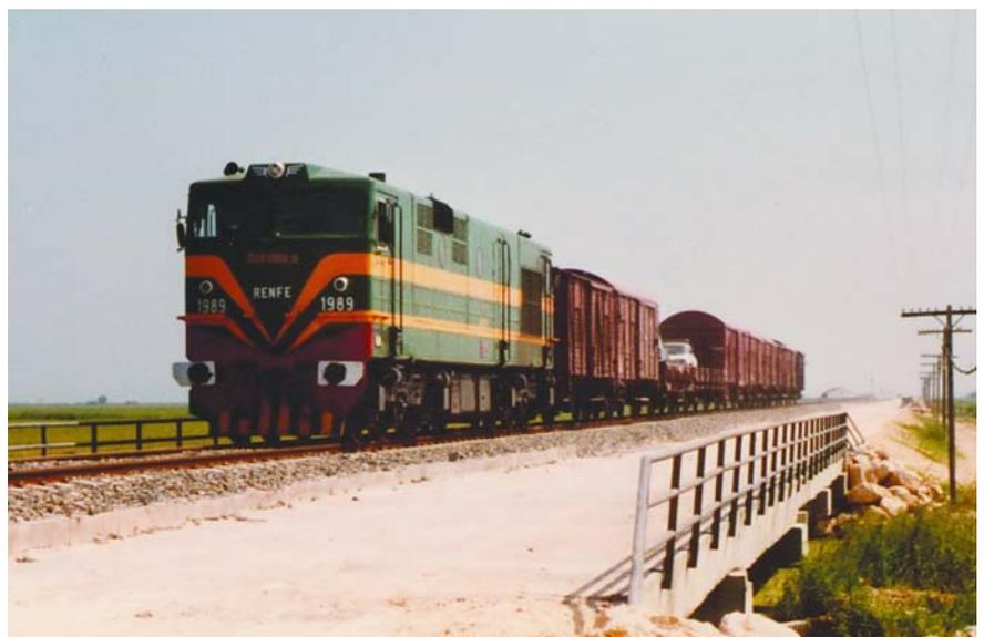
Un tren colector de vagón disperso circula por la larga recta entre Sollana y Sueca remolcado por una 319. A raíz de la voladura de los pontones en ese tramo durante las inundaciones de 1982, éstos se reconstruyeron preparados para la doble vía. Julio de 1985. Foto Esteban Gonzalo.
