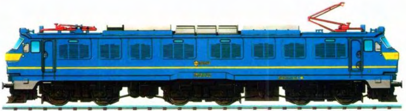
Locomotora serie 251 de 4.650 kw para 160 km/h.
