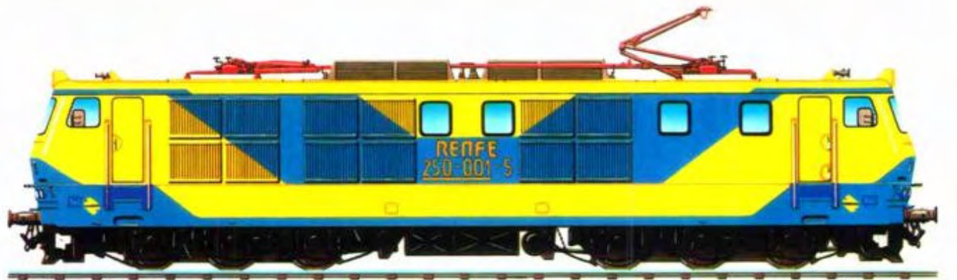
Locomotora serie 250 de 4.600 kw para 160 km/h.
