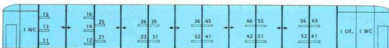
Coche-camas tipo YFT (11 cabinas).
