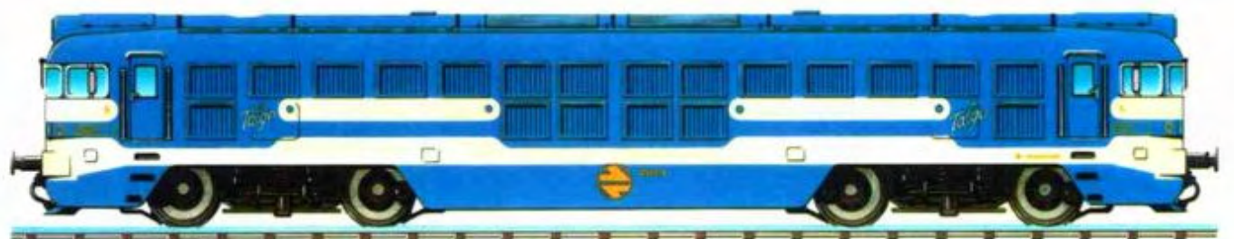
Locomotora serie 354 de 2.250 kw para 180 km/h.
