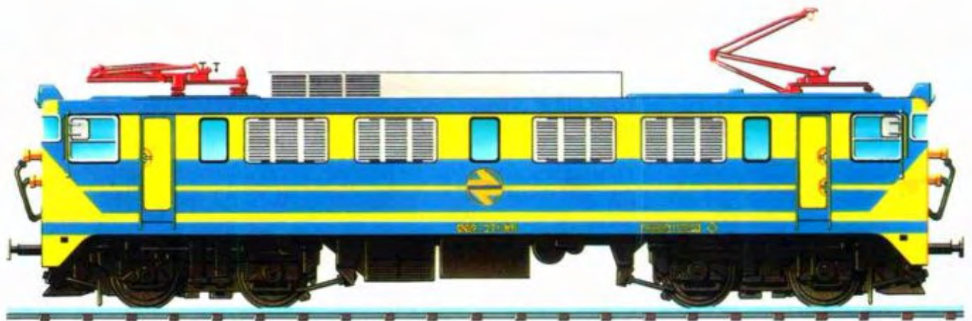
Locomotora serie 269 de 3.100 kw para 160 km/h.
