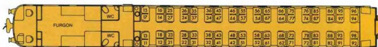
Coche motor con asientos de 2.ª clase (coche M-597).
