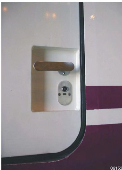
**Fig. 1-7 Cerradura electrónica de las puertas de acceso a la locomotora.**
