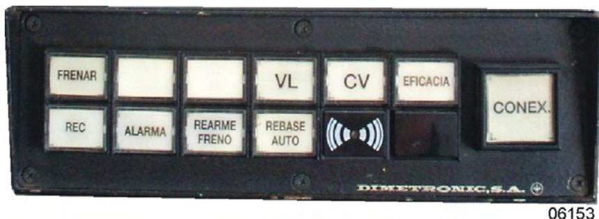
**Fig. 1-11 Panel equipo ASFA.**
