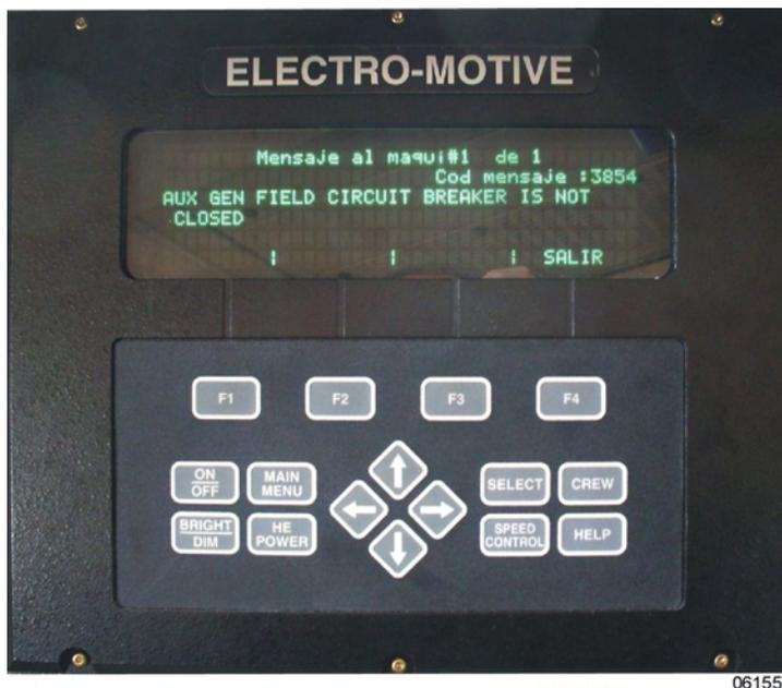
Figura 2-15. Display del microprocesador EM2000.
