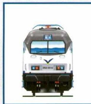
En cuanto a la tensión de electrificación, inicialmente las 15 máquinas de ancho estándar y 16 de las de ancho ibérico eran bicorriente (25 kV c.a./3 kV c.c.) y las la 44 últimas sólo tienen equipo de continua sustituyéndose el transformador por un bloque de hormigón de peso casi equivalente. Actualmente, las que funcionan en ancho es-
