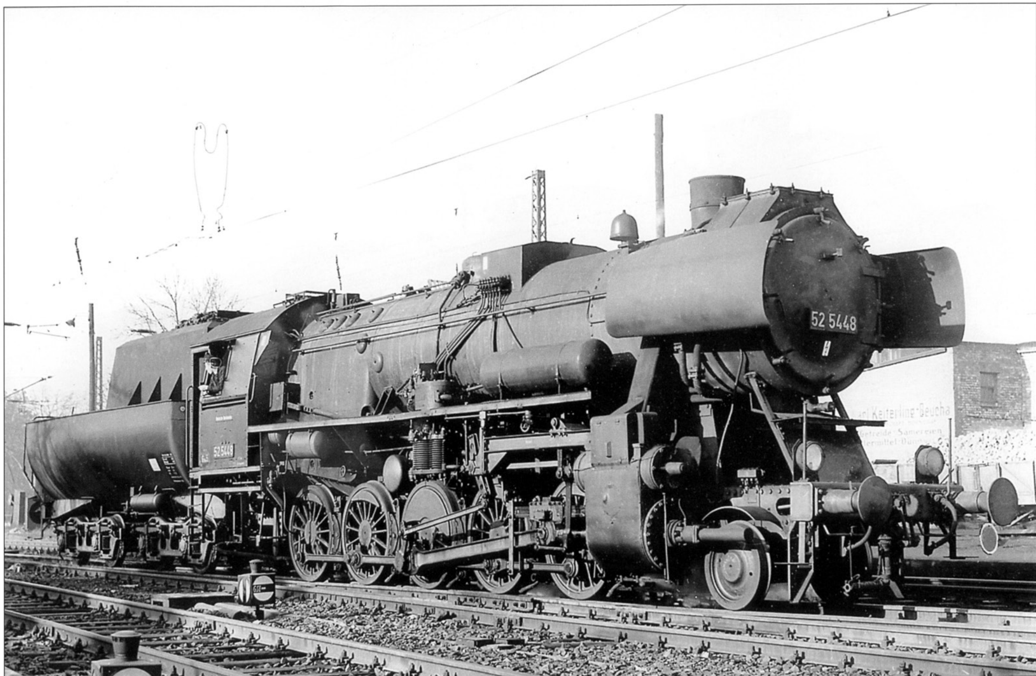
По сравнению с другими локомотивами № 52, 5448 имел круглую дымовую трубу, выпуклые дымоотбойники и литую несущую раму. Снимок сделан в октябре 1968 года.
