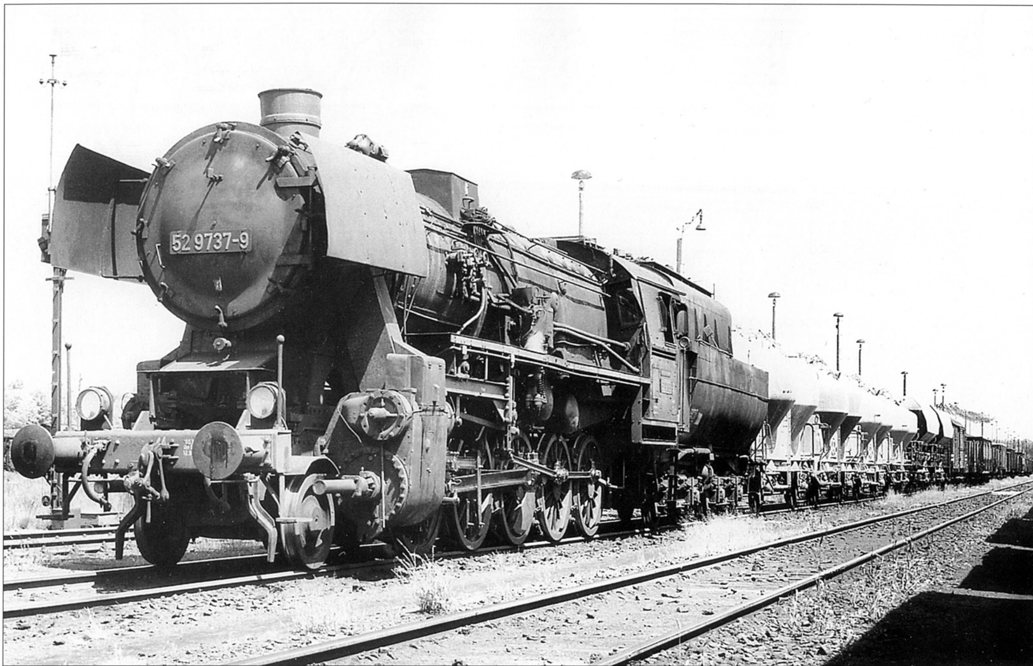
Готовый к отправлению паровоз № 52 9373 с пылеугольной топкой на станции Зефтенберг в июне 1973 года. Последний паровоз 52-й серии с таким способом сжигания был снят с эксплуатации в 1979 году и был передан на консервацию в Зефтенберг.
