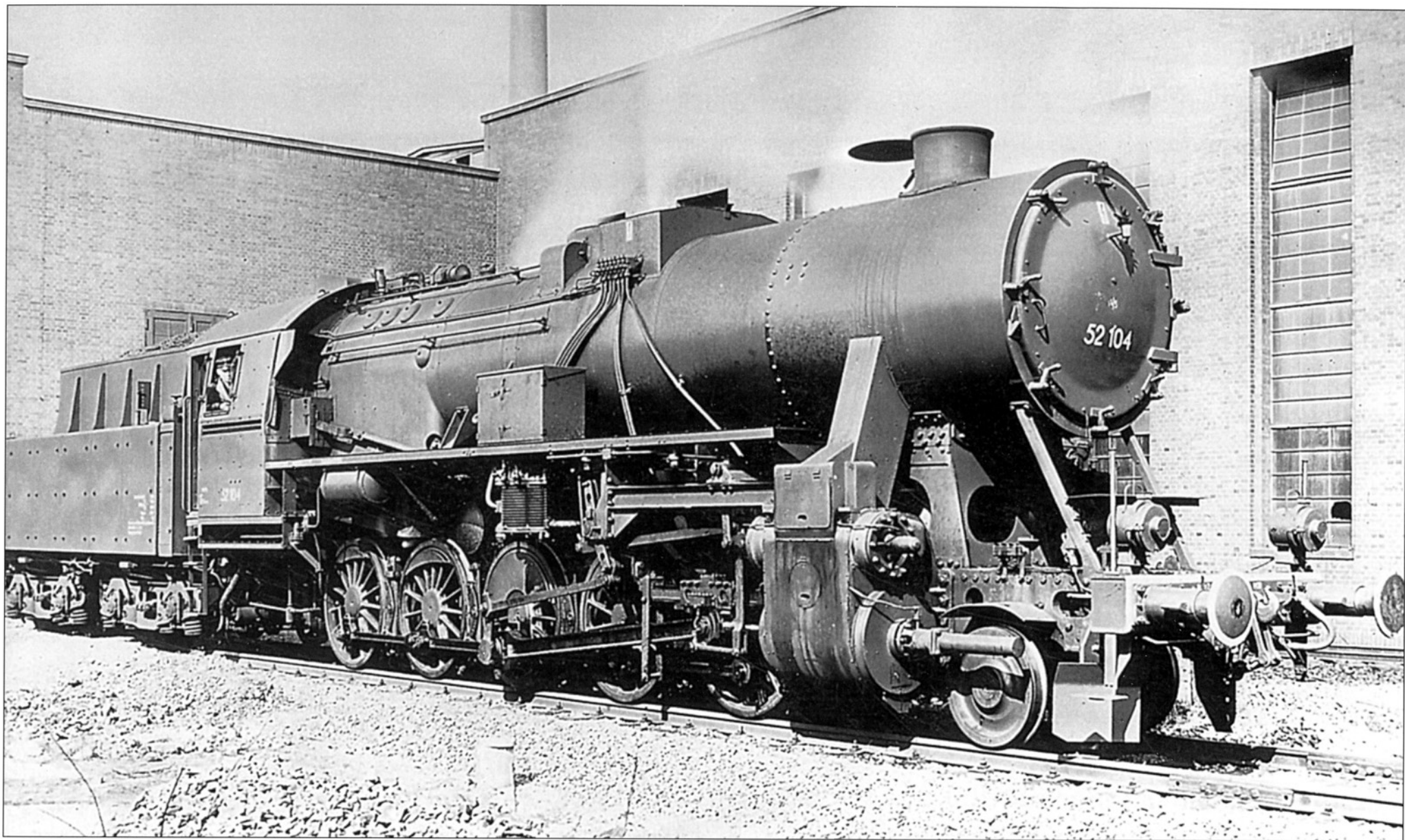
Некоторые паровозы 52-й серии были снабжены коробчатым тендером типа 2"2"Т 26, отчего были больше похожи на паровозы 50-й серии. Этот паровоз, оснащенный несущей рамой из листового металла, выпущен фирмой Краусс-Маффей в феврале 1943 года, его судьба после 1945 года осталась неизвестной.
