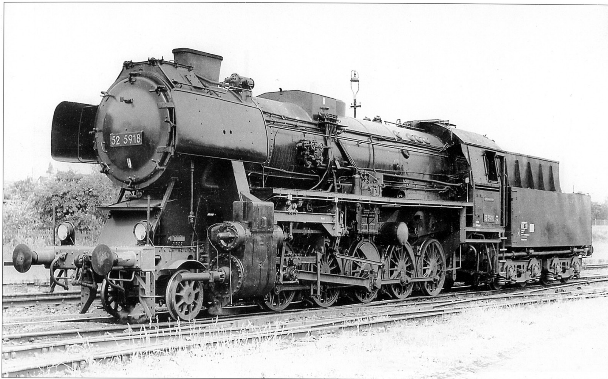
На паровозы серии 52-GR устанавливали тендер типа 2"2"Т 26, смешанным подогревателем они напоминали паровозы серии Reko-52. Этот локомотив № 52 5918, оснащенный литой несущей рамой, был сфотографирован в июле 1968 года.
