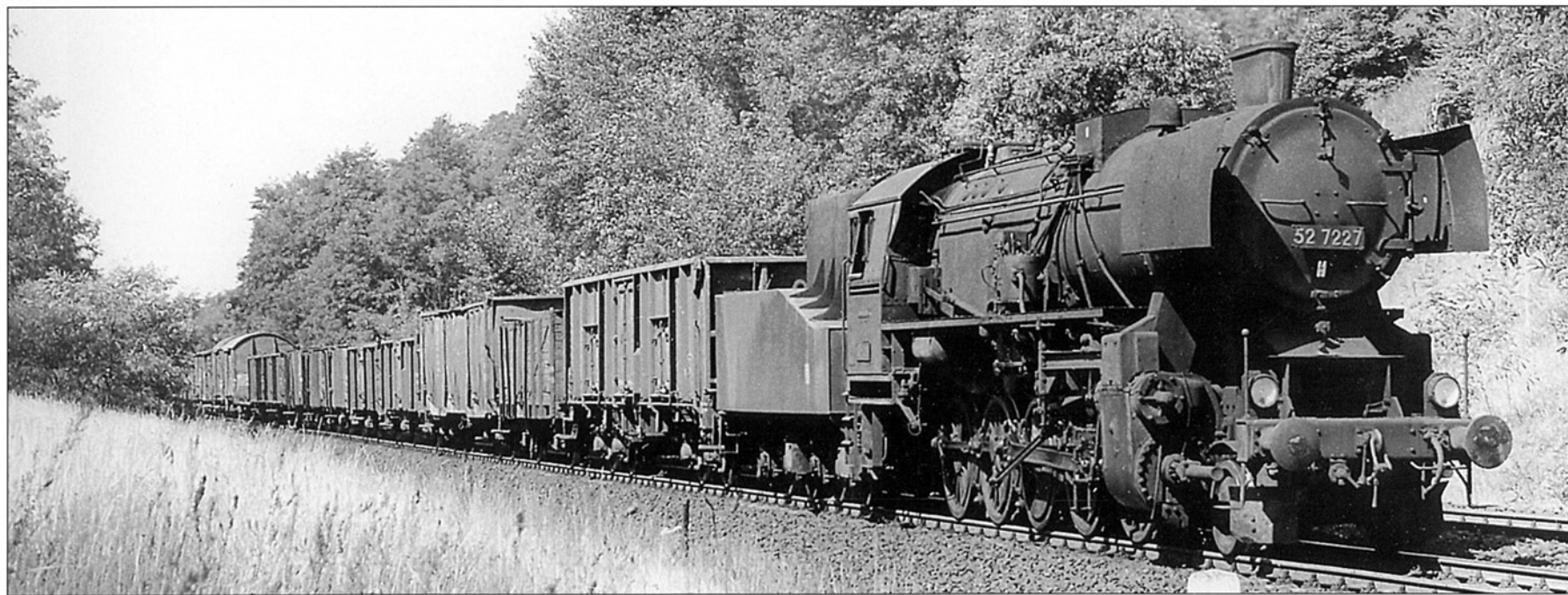
Инжектор Гисла, дымоотбойники Витте и тендер с жестким крепле- нием определили внешний вид паро- воза № 52 7227, сфотографирова- нного в августе 1969 года и направляю- щегося из Берлина в Розенгартен (район Франкфурт на Одере).
