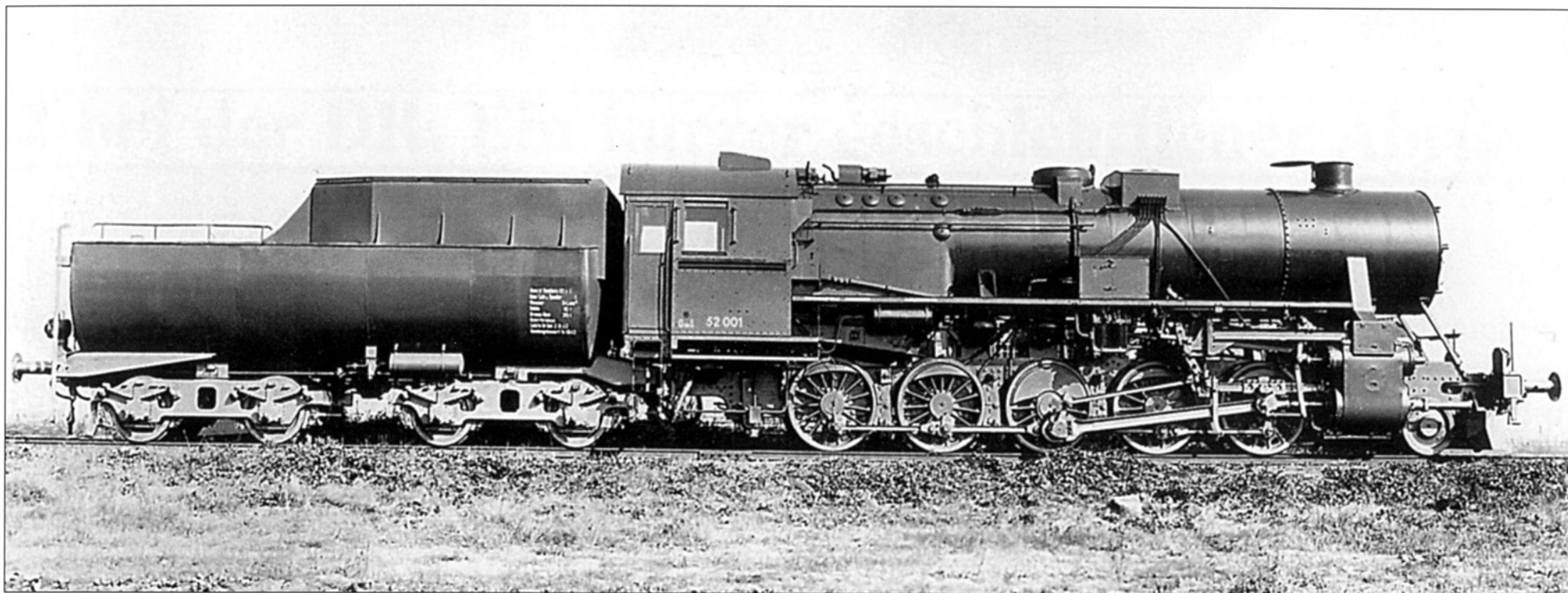
На этой фотографии показан эталон паровоза 52-й серии, представленный в сентябре 1942 года, его номер 52 001. Внешний вид нового военного локомотива KDL 1 показывает, что у него отсутствуют дымоотбойники и он оснащён удлиненным тендером ваннообразной формы нового типа.
