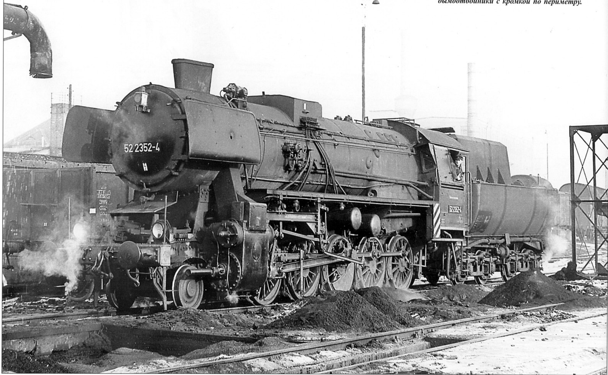
Паровоз № 52 2352 (локомотивное депо Баутцен) снабжен инжектором Гисла, дымоотбойники с кромкой по периметру.
