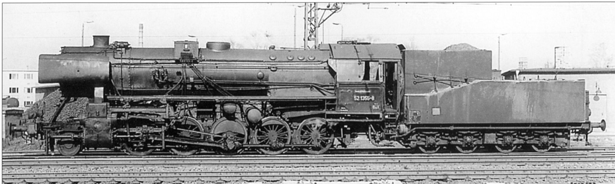
На № 52 1355 заметны не только литая несущая рама и отсутствие насадки на дымовой трубе, но и тип тендера с жесткой рамой, определивший внешний вид этого паровоза 52-й серии. Локомотив из Энегльсдорфа стоит на станции Вурцен, март 1972 года.
