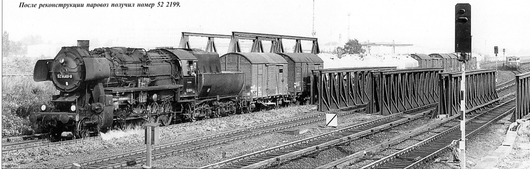
На паровозе № 52 8031 (бывший № 52 3550) заметны не только инжектор Гислера, но и звонок. Он использовался на второстепенных линиях. Фотография сделана в апреле 1972 года в районе Берлин-Фридрихсхаген. Паровоз был приписан к локомотивному депо Франкфурта на Одере.
