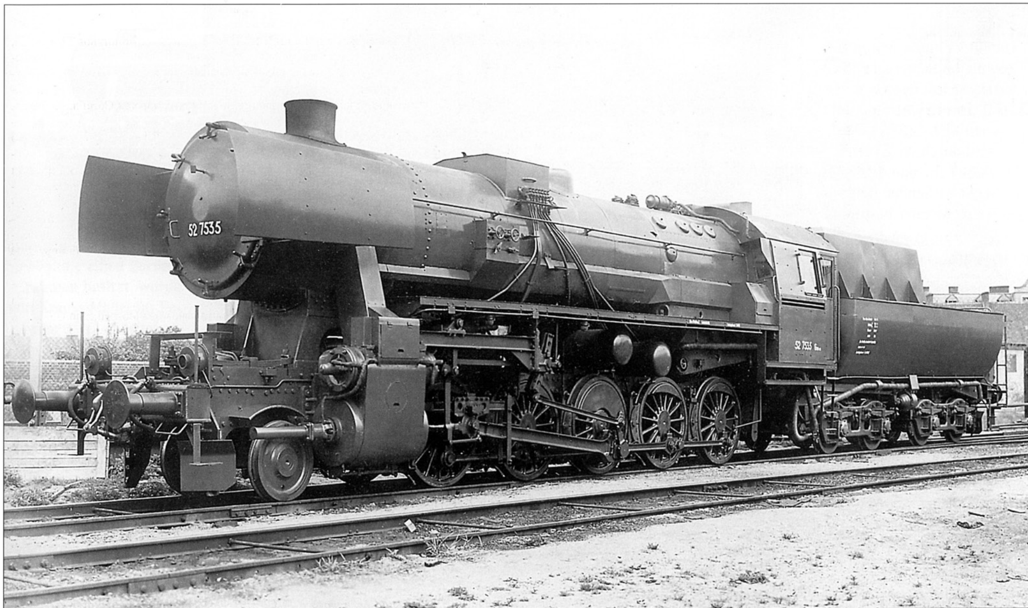
Новый паровоз № 52 7535, построенный в мае 1944 года в Шихау, сразу после выхода с завода. Дымовая труба без крышки, важнейшие части парового котла имеют защитное покрытие от морозов, часть ходового колеса без спиц, дымоотбойники упрощенного типа и тендер ваннообразной формы - создают типичную картину военного локомотива. Этот паровоз, оснащенный несущей рамой из листового металла, остался после 1945 года в Германии.
