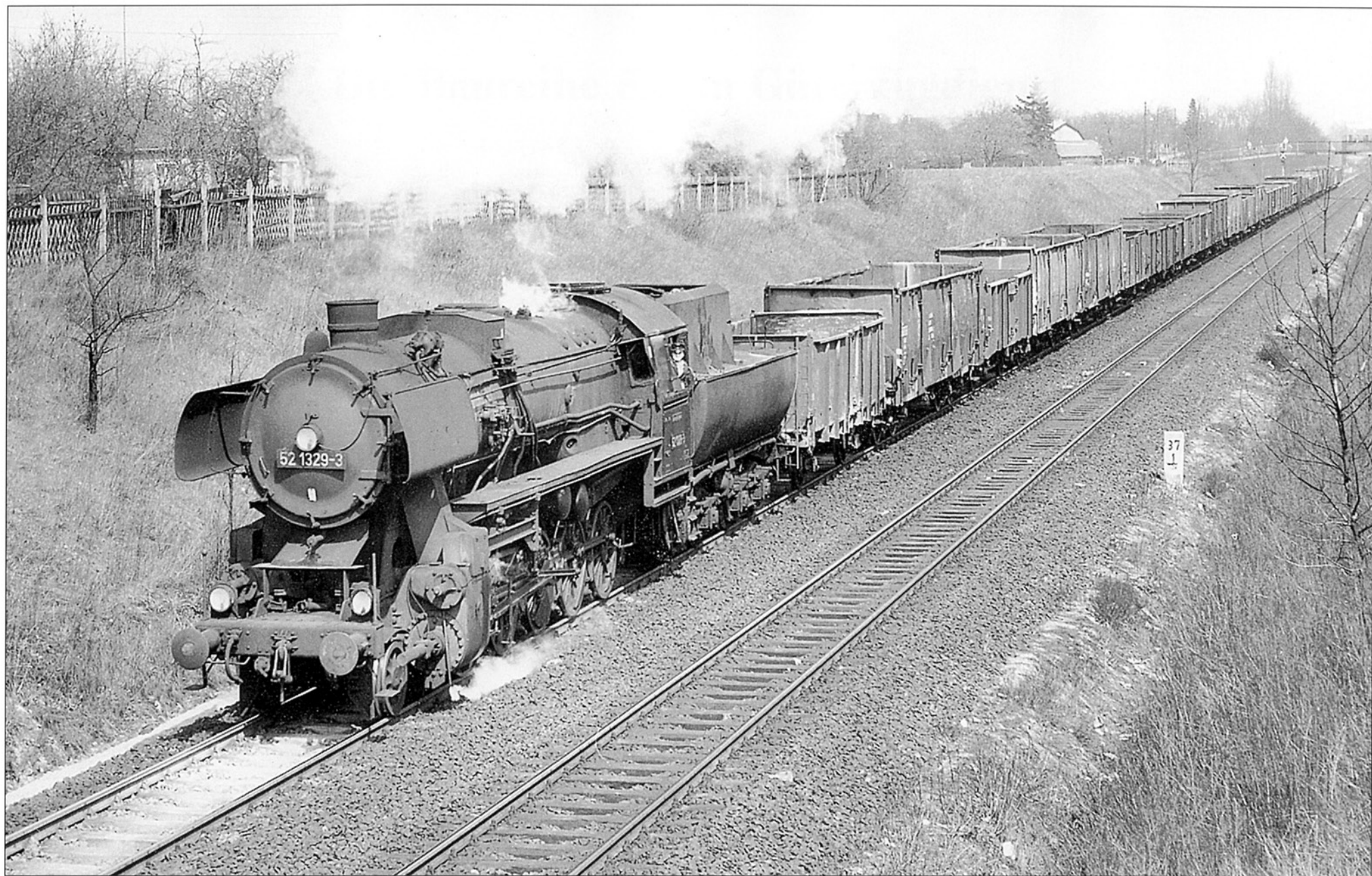
Этот паровоз, сфотографированный 23 апреля 1973 года вблизи Грюнбергале под Берлином, имел третий прожектор на передней крышке дымовой камеры.
