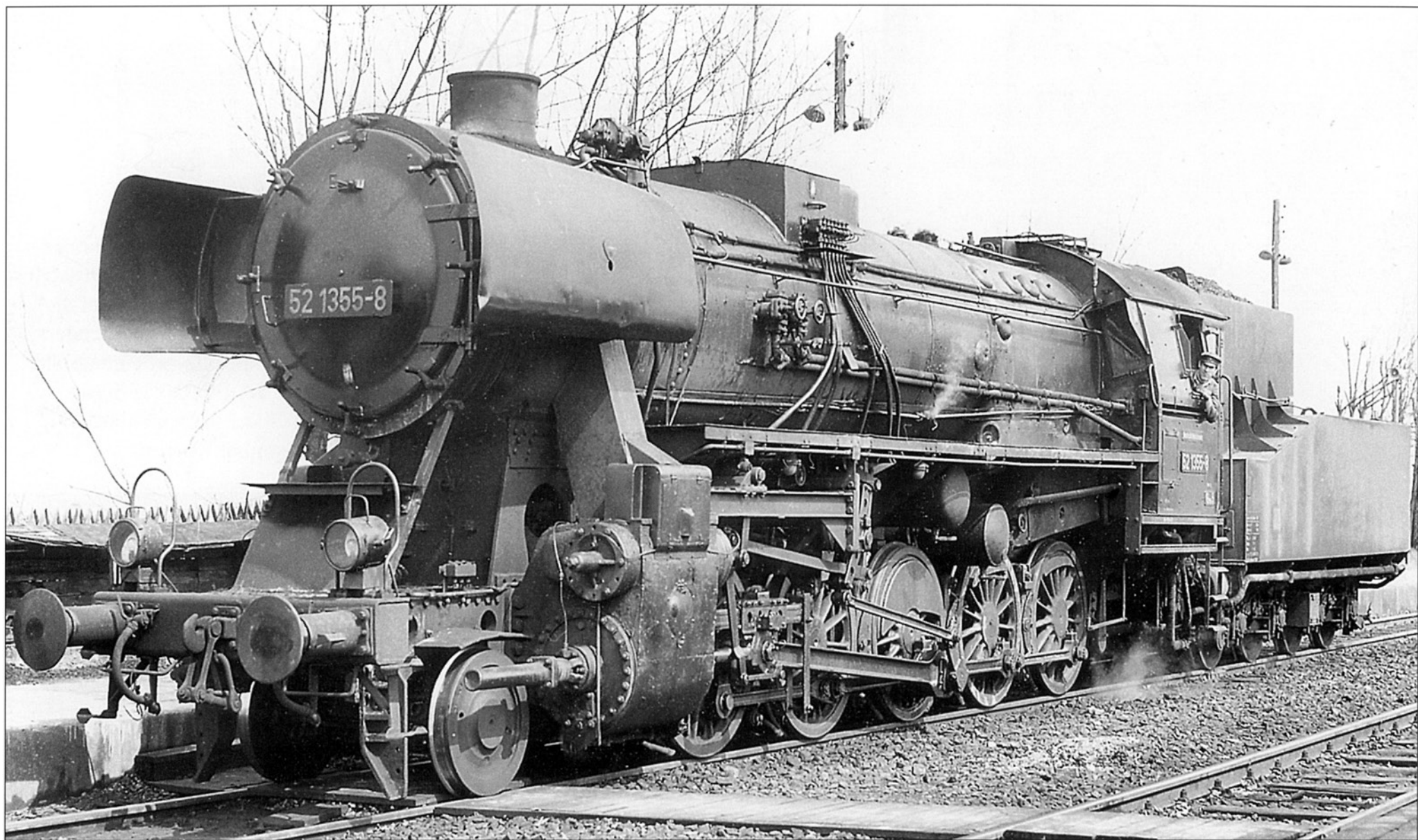
Ещё один снимок паровоза № 52 1355, классический ракурс со стороны кочегара был сделан 23 апреля 1973 года в Шёнефельде под Берлином. Локомотив отличался установкой иного типа прожекторов, защищенных бугелем. Такими прожекторами оснащались обычно паровозы 50-й серии.
