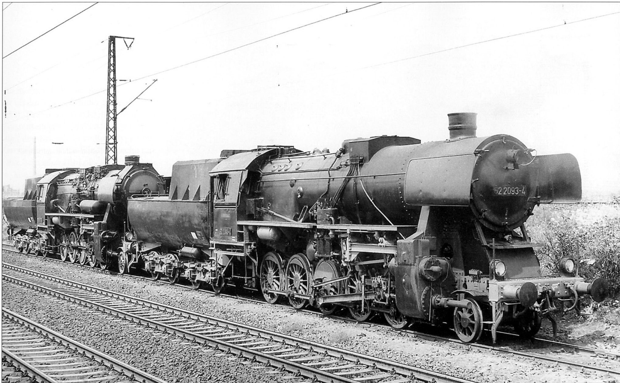
Ещё один локомотив с литой несущей рамой. Фотография сделана в сентябре 1975 года по пути из Рав Стендаль в Лейпциг. Позади № 52 2093 стоит паровоз серии Reko-52. На его правой стороне видны баллон сжатого воздуха, смесительная коробка подогревателя на дымовой камере.
