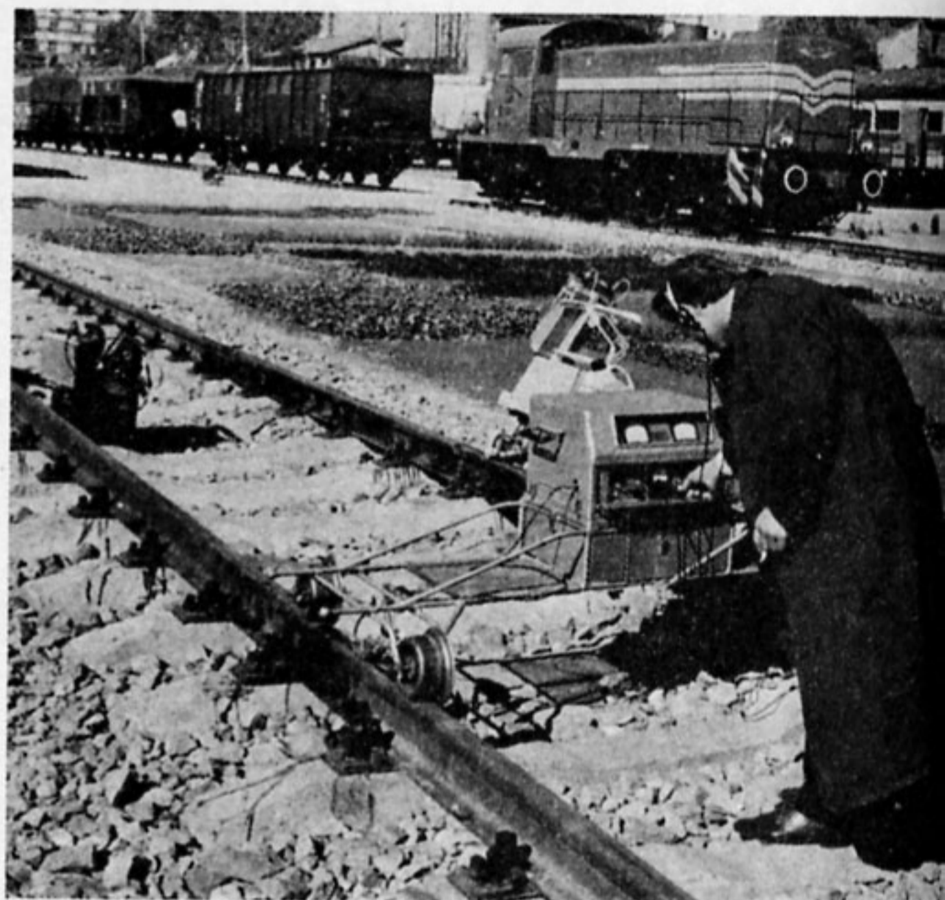
253. Defektoskopowe badanie szyn
