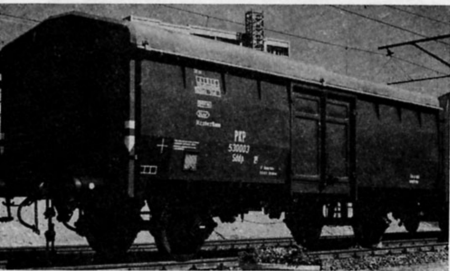
229. Wagon kryty z przesuwным dachem
