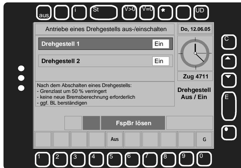
Wird der Hauptschalter auf Grund eines Fehlers in der Antriebssteuerung (z.B. ASG-Störung) ausgeschaltet, so lässt er sich erst wieder einschalten, wenn das gestörte Drehgestell abgeschaltet wurde.
