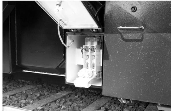
Die Batteriespannung wird durch das Integrierte Steuergerät (ISG) und zusätzlich durch ein Unter-/ Überspannungsrelais überwacht. Dies schaltet bei Überspannung das Batterieladegerät ab. Bei Unterspannung erfolgen mehrere Warnmeldungen.
