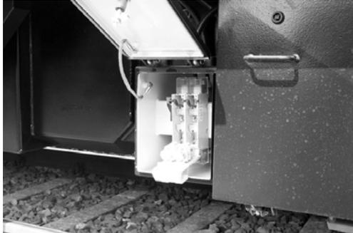
Batteriesicherungen außen am Fahrzeug.
