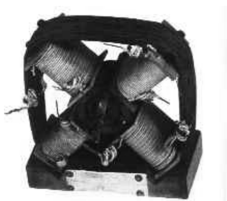
Fig. 1 - Prototipo del motore di Galileo Ferraris
