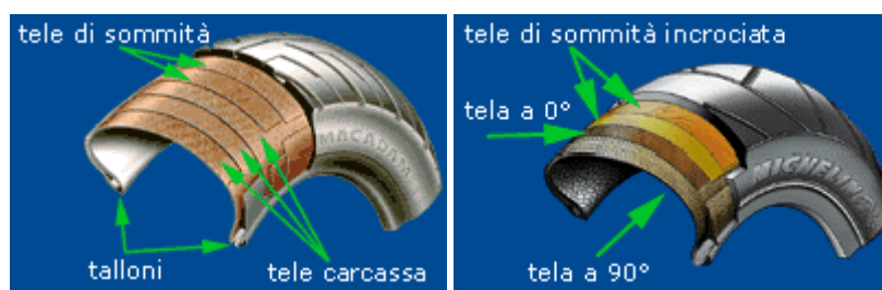
Figura 6 – Pneumatico convenzionale (a sinistra) e radiale (a destra)
