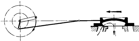
Fig. 36 Le tiroir ouvre l'échappement
