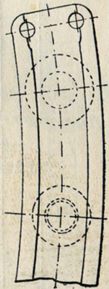
Fig. 162. — Flasque de coulisse de Stephenson montrant l'entrée sur laquelle se monte l'entretoise, de manière à permettre la rectification de la coulisse à la meule, sans changer les entretoises.
