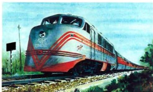
Locomotora 350 (antigua serie 1-4T) construida en EE.UU. en 1949 para el remolque del Talgo II. (Serie de 4 unidades).
