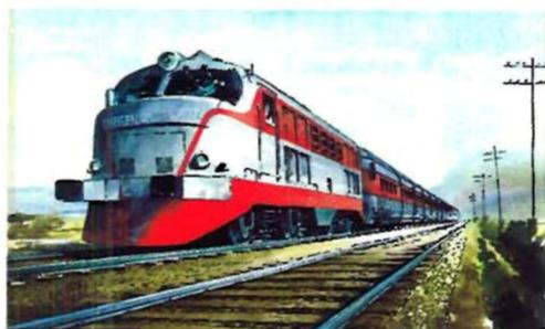
Locomotora serie 352 (antigua serie 2000T) construida en 1964 para el Talgo III. El récord de velocidad de estas locomotoras es de 200 km/h. (Serie de 10 unidades).
