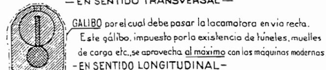
GALIBO por el cual debe pasar la locomotora en via recta. Este galibo, impuesto por la existencia de túneles, muelles de carga etc., se aprovecha al máximo con las máquinas modernas.
