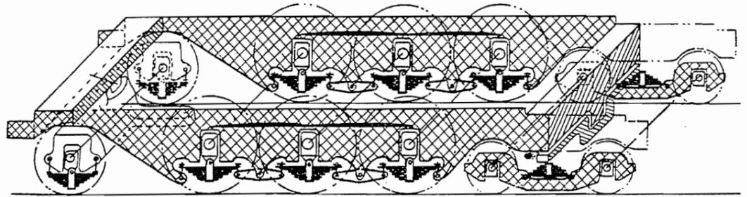
En este caso, se observan las particularidades de las suspensiones con muelles independientes y con balancines compensadores. El reglaje de los muelles permite hacer variar las cargas que actuan sobre el bogie, el conjunto de los ejes acoplados, o sobre el bissel. La presencia del balancin asegura un reparto invariable de las cargas entre los ejes acoplados.
