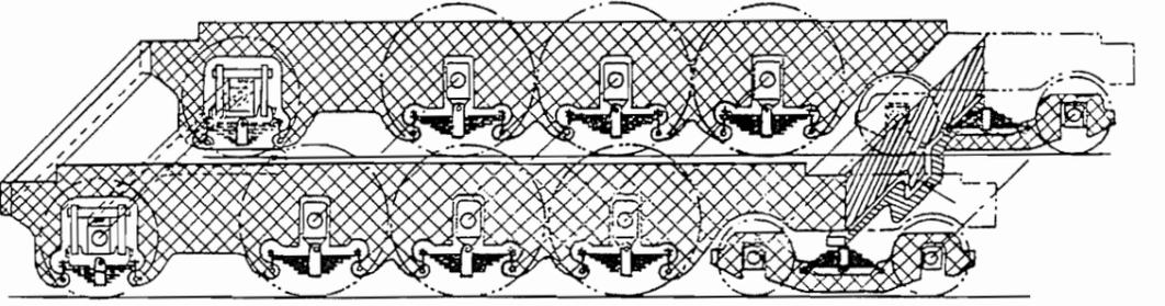
Esta solucion permite obtener exactamente las cargas por eje deseadas, mediante reglaje, pero este reparto se modificara en marcha al paso por los desniveles de la via. Se reduce el efecto de los desniveles adoptando muelles de mayor flexibilidad, pero en este caso estamos limitados por la necesidad de conservar una buena estabilidad de la locomotora a grandes velocidades
