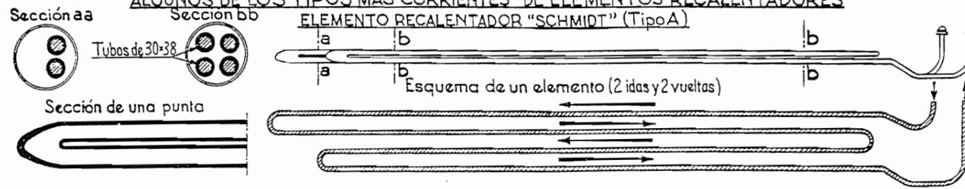
De construcción barata y reducido entretrenimiento (punta obtenida por forjado), este elemento se aplica en todas las locomotoras con recalentador de la Renfe. No obstante, en locomotoras modernas forzadas, del extranjero ya no se utiliza, pues dificulta el tiro y origina sensibles pérdidas de agua en el circuito de vapor.
