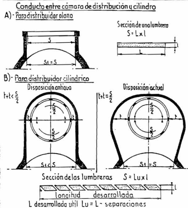
El distribuidor cilíndrico sustituyendo al plano no ha proporcionado siempre una franca mejora de las secciones de paso, debido a que las secciones eran insuficientes. La forma adoptada en los cilindros modernos ha subsanado este grave defecto, cuya supresión ha permitido en algunas casos, mejorar sensiblemente el motor existente, sin cambiar el distribuidor.
