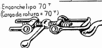
Las reacciones instantaneas producidas en los arranques o en los frenados efectuados torpemente, pueden alcanzar valores muy superiores al esfuerzo medio de tracción F
