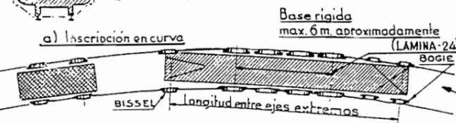
La inscripcón en curva de pequeño radio, de las grandes locomotoras modernas solo puede resolverse recurriendo a los dispositivos portadores-guías: bissel, bogie etc., (LAMINA 24)
