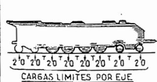
Las cargas limites de 20 T. por eje y de 7,5 por metro lineal de via son un obstaculo para la construcción de locomotoras compactas. El peso total de la máquina, limitado por estos dos valores y por las dificultades inherentes al aumento del
