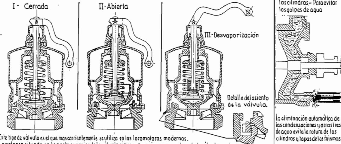
Este tipo de válvula es el que más corrientemente se utiliza en las locomotoras modernas. La palanca situada en la parte superior de la válvula sirve para accionar manualmente la válvula en cualquier caso de emergencia o para comprobar su buen funcionamiento.
