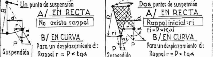
Legenda: — Posición biela con locomotora en recta en curva
