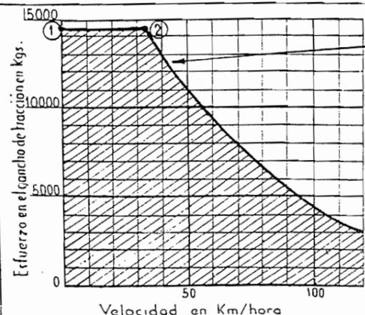
para un régimen de combustión constante de 500 kg/m<sup>2</sup>/hora que representa el límite superior en condiciones de utilización normal (Lámina 6)
