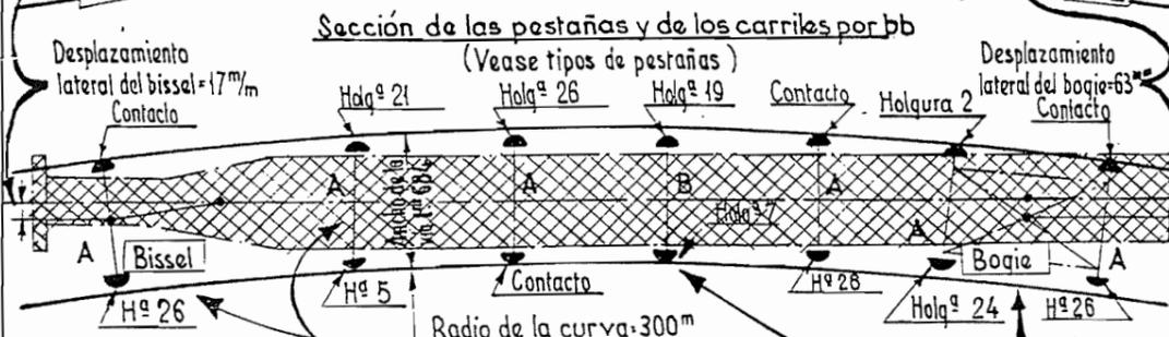
Desplazamiento lateral del bissel = 17 mm/m
