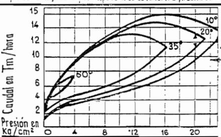
**Caudal del inyector en función de la temperatura del agua de alimentación y del timbre de la caldera.**
