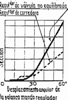
En los dos casos, la apertura hasta en 1/2 carrera permite laminar el vapor en el regulador para reducir la presión en las cajas de distribución. Esta posibilidad (prevista para evitar los tirones en el arranque) no debe utilizarse más que excepcionalmente para regular el esfuerzo de tracción, pues el laminado (equivalente a una expansión sin trabajo útil) es una causa de pérdida en el rendimiento.
