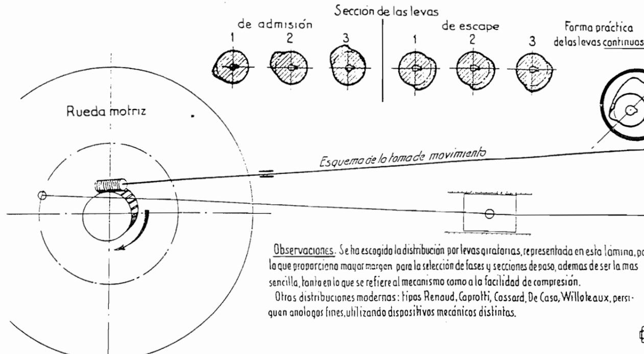
Observaciones. Se ha escogido la distribución por levas giratorias, representada en esta lámina, por ser la que proporciona mayor margen para la selección de fases y secciones de paso, además de ser la más sencilla, tanto en lo que se refiere al mecanismo como a la facilidad de compresión.
