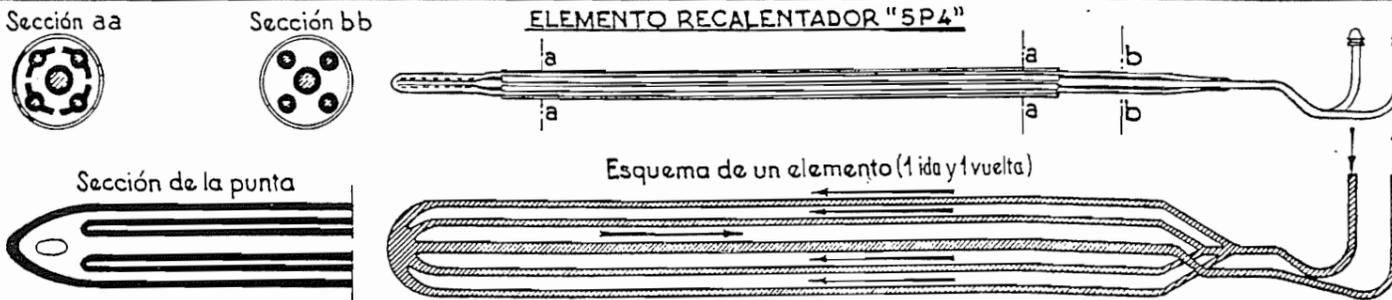
Las aletas longitudinales soldadas sobre cada uno de los tubos periféricos evitan el enfriamiento del vapor que circula por el centro del elemento. De eficacia parecida a la del elemento Houlet, permite realizar un alto grado de recalentamiento, sin dificultar el tiro y la circulación del vapor. Su punta obtenida por forjado, sin metal de aportación, le garantiza un buen resultado a alta temperatura.
