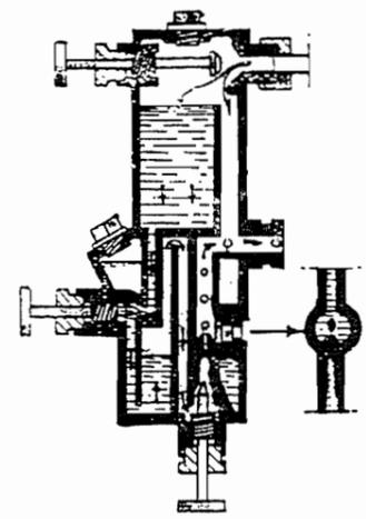
Sección esquemática de un engrasador mecánico
