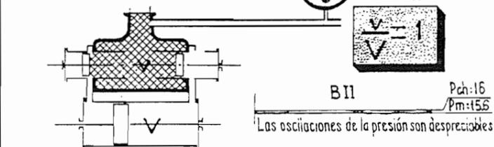
Siendo discontinuo el flujo de vapor (según el grado de admisión) se producen, en una cámara de vapor pequeña, altas velocidades instantáneas que provocan una pérdida de carga pi superior a p.m. (p es proporcional al cuadrado de la velocidad). La cámara de distribución del caso BII permite amortiguar muy eficazmente las oscilaciones de la presión.
