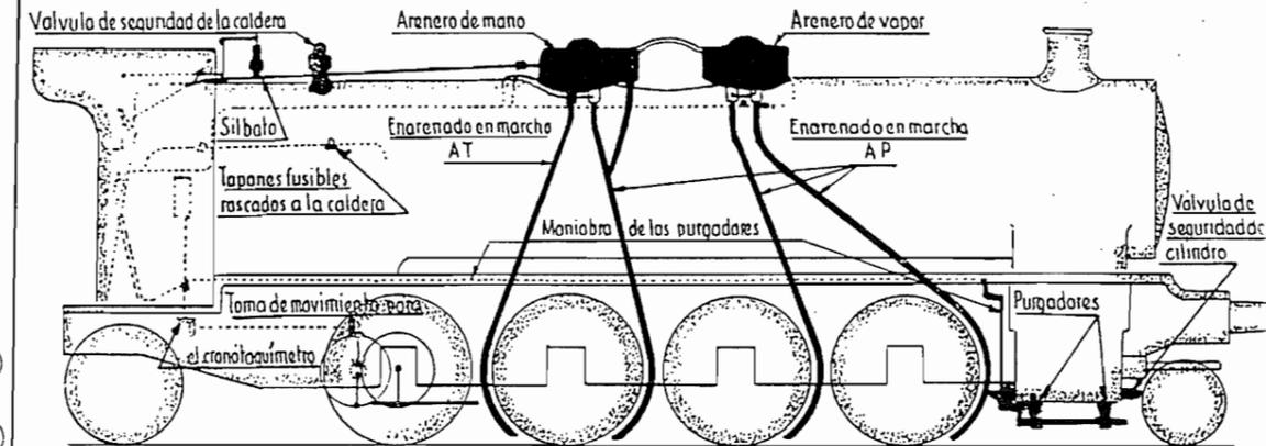
Instalación de areneras: Permite, mediante la proyección de arena bajo las ruedas, aumentar el coeficiente de adherencia a 0,3 aproximadamente facilitando así el arranque y el arrastre en rampa de trenes pesados.
