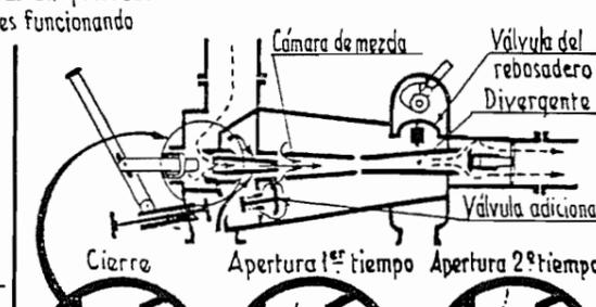
Este tipo de inyector corresponde al representado en el esquema de principio. El agua llega por su propio peso a la cámara de mezcla donde el vapor solo tiene por misión el arrastrarla. En este caso, el agua que viene del tender puede estar a temperatura más alta que con un inyector aspirante, pues no es de tener la aspiración del vapor producido por el agua.
