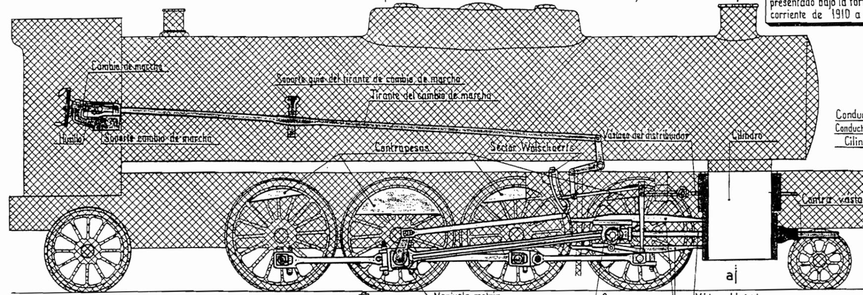
Las vistas se refieren al motor mas sencillo (dos cilindros exteriores y simple expansión) presentado bajo la forma constructiva mas corriente de 1910 a 1930.
