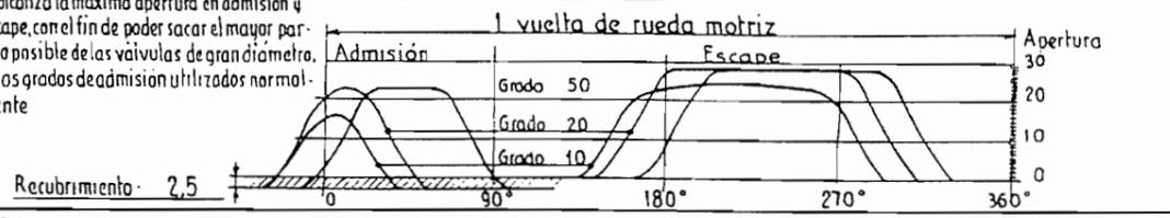
Observaciones: A partir del 20% de admisión, se alcanza la máxima apertura en admisión y escape, con el fin de poder sacar el mayor partido posible de las válvulas de gran diámetro, en los grados de admisión utilizados normalmente
