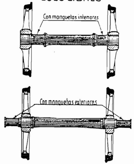
Sobre el eje recto, fabricado con acero categoria D ( $R=48 \text{ Kgs/mm}^2$ ) se calan enfria, con prensa los centros de rueda de acero moldeado, con un aprieto de  $\frac{1}{5000}$  aproximadamente del diametro de la parte de calaje. La presión de calaje es del orden de  $80 \text{ T}$ . La muñequillas matrices y de acoplamiento se calan en condiciones similares. Los contrapesos dispuestos en el centro de rueda equilibran las masas en rotación. (muñequillas, cabezas de bielas de acoplamiento)
