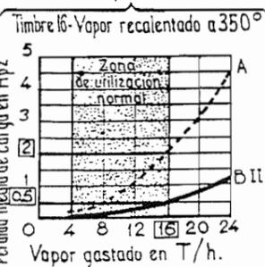
La circulación del vapor por los tubos de admisión produce una caída de presión o pérdida de carga p cuyo valor depende:
