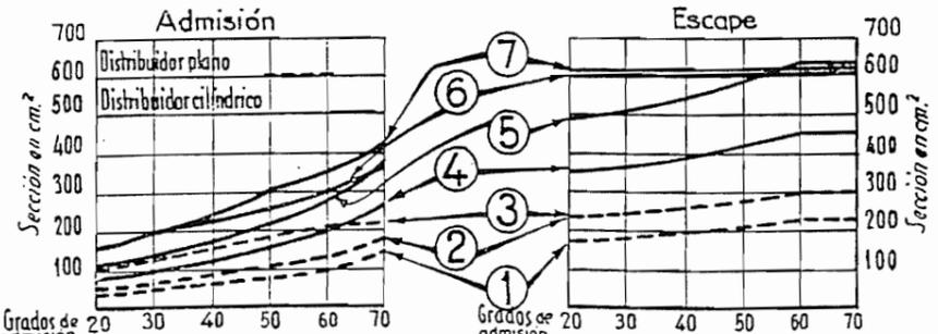
Observaciones: Las secciones correspondientes a los distribuidores sencillos 1, 2, 4 y 5 aumentan regularmente en función de los puntos de admisión (Véase curvas de apertura en % Lámina 13). Por el contrario, con los otros distribuidores, las curvas son irregulares en cuanto la sección descubierta es superior a la sección de los canales correspondientes.
