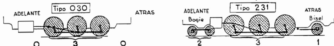
EJEMPLOS - Locomotora nº185 tender, bisel delantero, 4 ejes acoplados, sin ejes libres traseros y 2 cilindros: 140-2185
