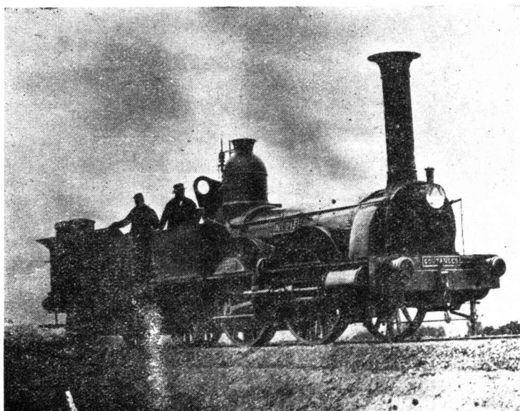
Bild 1. B 1 P. Lok. der frz. Westbahn, Nr. 215 „Coutances“, gebaut 1855 von Buddicom & Co. in Rouen.
