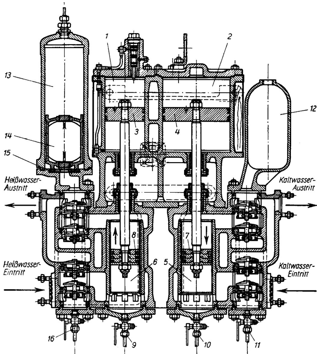
Bild 43. Mischvorwärmerpumpe VMP 15-20
