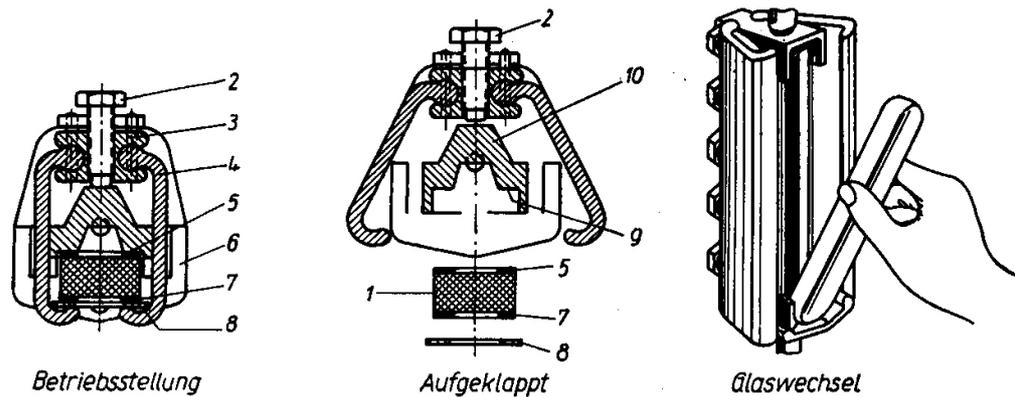
Bild 52. Auswechseln des Glases des „Cardo“-Wasserstandes
