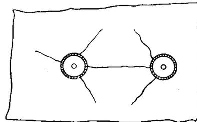
Bild 3. Strahlenrisse und Stegriß zwischen zwei Stehbolzen
