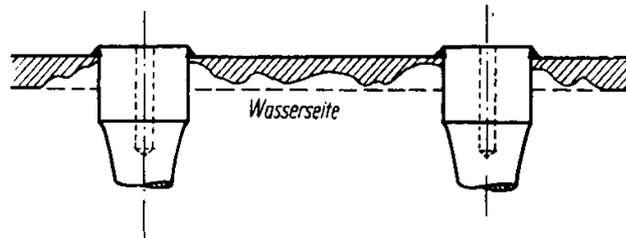
Bild 10. Korrosionen auf der Wasserseite der Stahlfeuerbüchse
