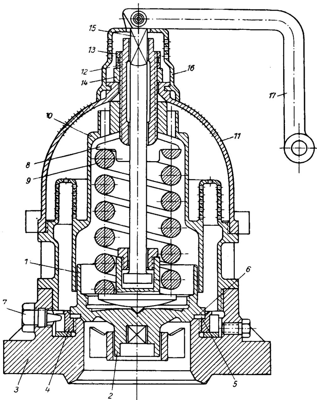
Bild 53. Coale-Sicherheitsventil
