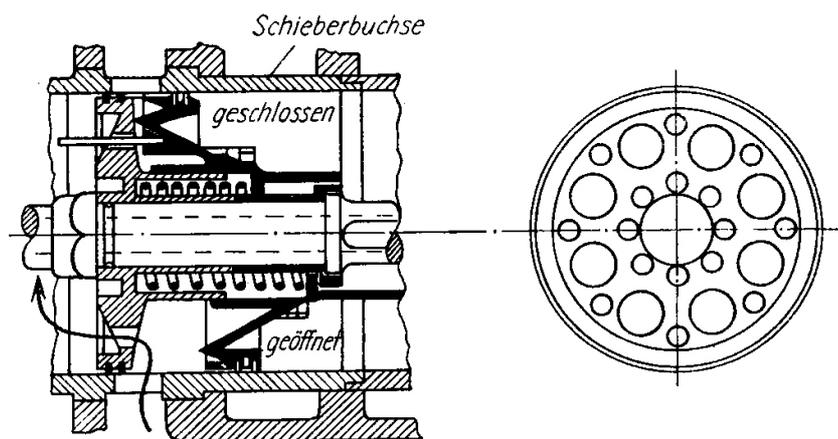
Bild 77. Karl-Schulz-Druckausgleich-Kolbenschieber
