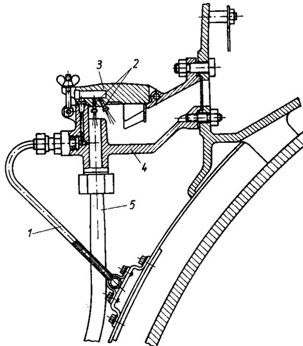
Bild 107. Sandstreuung am Sandkasten mit Sandtreppe
