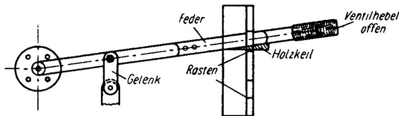
Bild 39. Ventilhebel des Tenderabsperrventils mit behelfsmäßig vergrößertem Hub.
