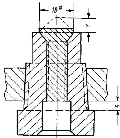
Bild 14. Schmelzpfropfen (Schnittzeichnung)
