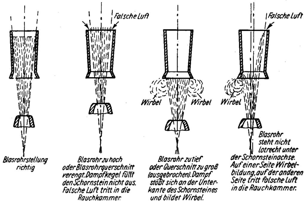
Bild 62. Fehlerhafte Saugzugverhältnisse
