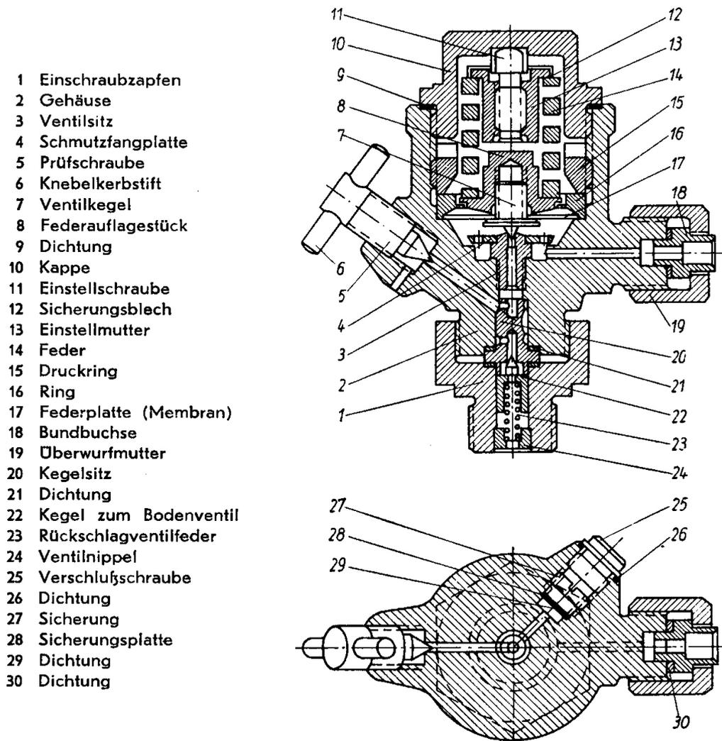
Bild 113. Öl-Absperrentil Bauart Michalk
