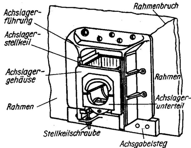
Bild 99. Verfahren einer Lokomotive zum Nachstellen der Achsstellkeile
