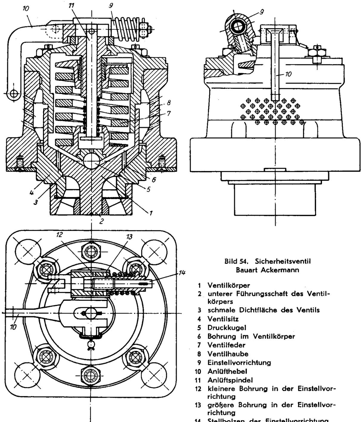
Bild 54. Sicherheitsventil Bauart Ackermann
