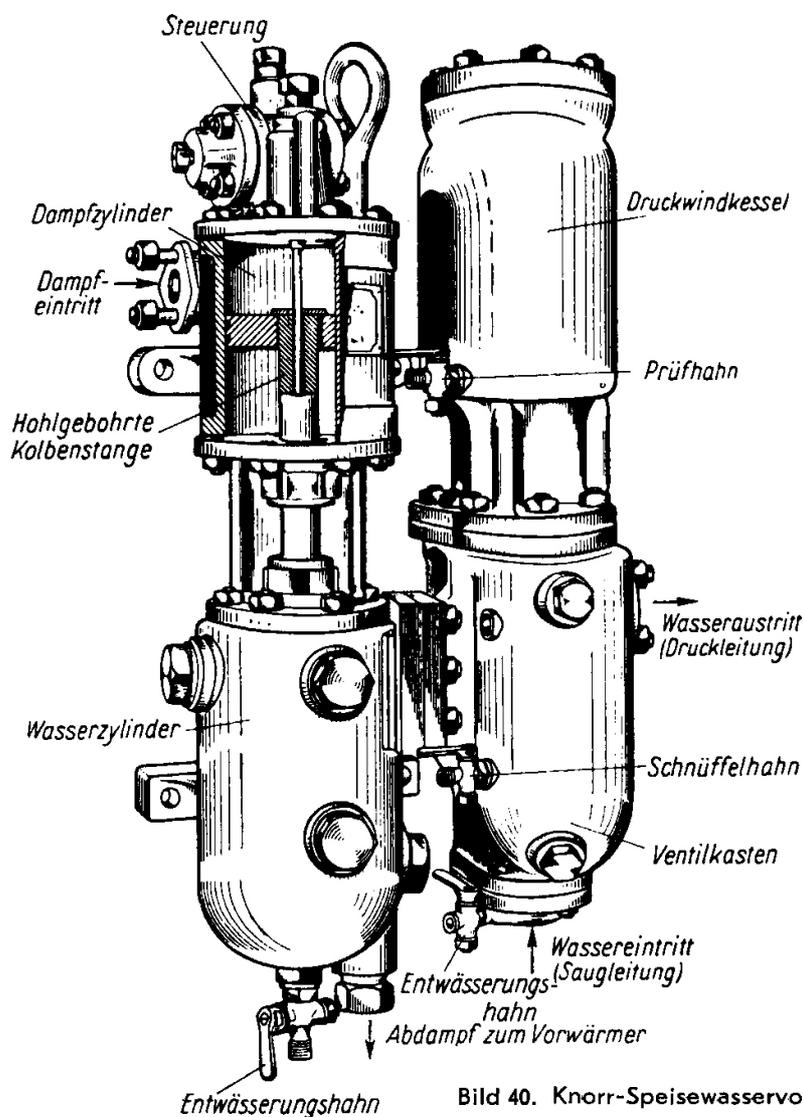
Bild 40. Knorr-Speisewasservorwärmerspumpe
