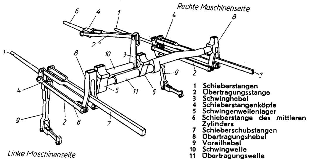
Bild 118. Steuerung der Dreizylinderlokomotive der Baureihe 58<sup>10-21</sup>
