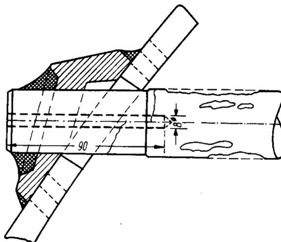
Bild 25. Queranker mit Anrissen und Korrosionen
