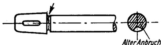
Bild 67. Bruch der Kolbenstange im Hals
