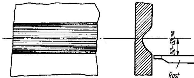
Bild 11. Abzehrung der Feuerbüchse durch Schwefeldioxyd (Prinzipiskizze)
