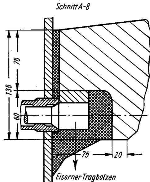
Bild 35. Feuerschirmtragbolzen
