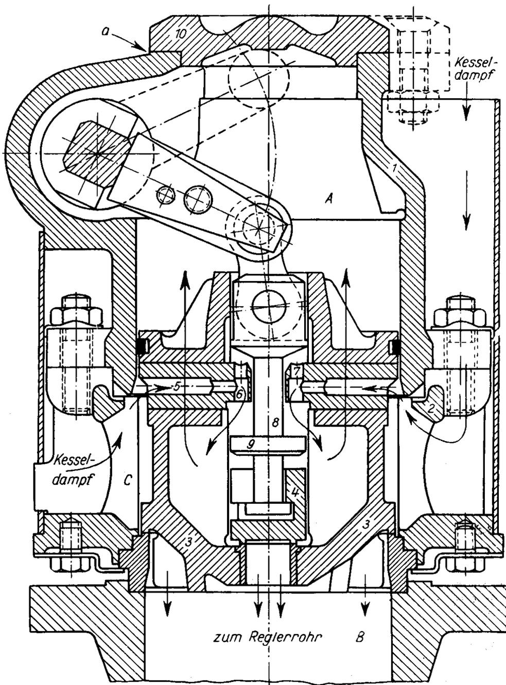
Bild 57. Ventilregler Bauart Wagner — Einheitsbauart —
