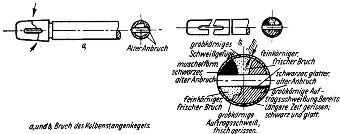
a, und b, Bruch des Kolbenstangenkegels.
