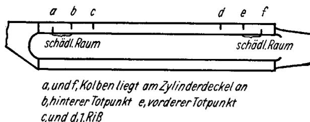
Bild 65. Gleitbahn mit Lagen der Totpunkte und schädlichen Räume
