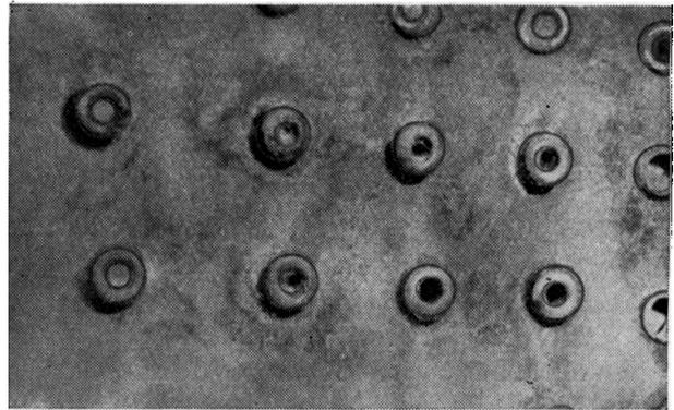
Bild 12. Abzehrung einer kupfernen Feuerbüchse durch Schwefeldioxyd
