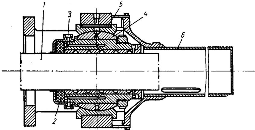
Bild 68. Kolbenstangentragbuchse
