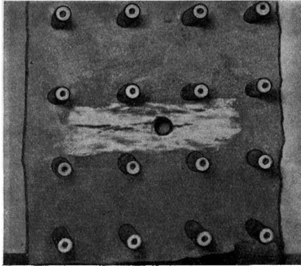
Bild 9. Durch Kesselstein ausgebeulter Stahlvorschuh zeigt wasserseitig Rißbildungen
