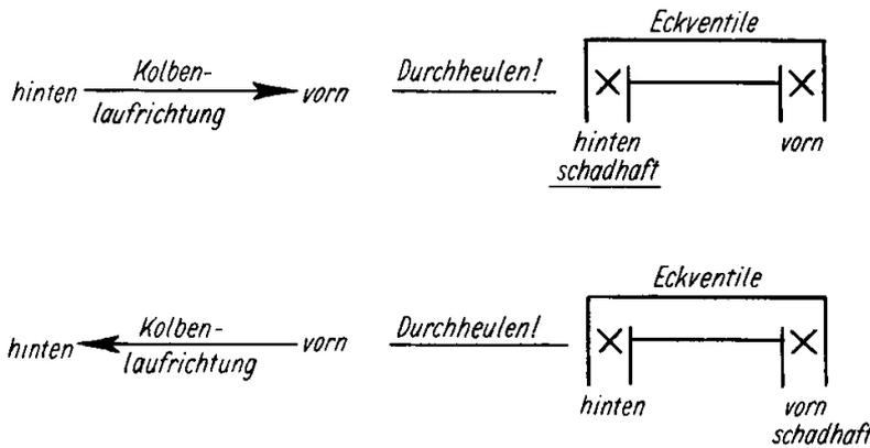
Bild 76. Kolbenlaufrichtung und schadhaftes Eckventil
