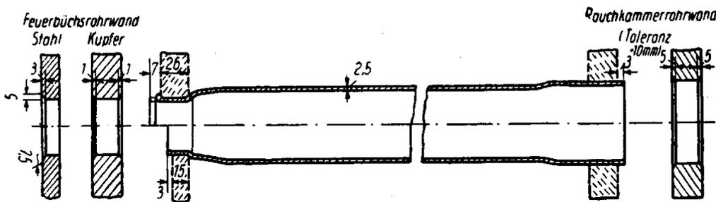
Bild 29. Festeingewalztes und gebördeltes bzw. geschweißtes Heizrohr
