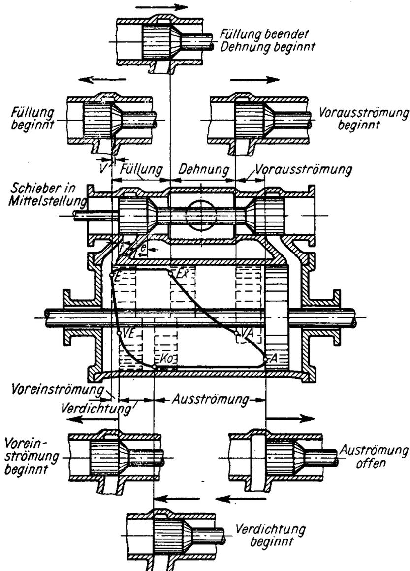
Bild 72. Dampfdruckschaubild mit Schieberstellungen
