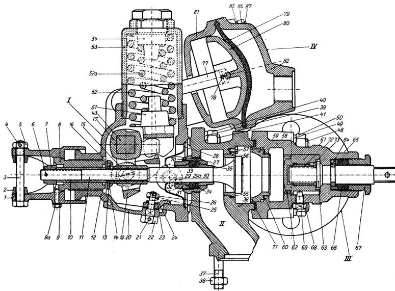
Bild 48. Gestra-Abschlammentil (Abschlammautomat)
