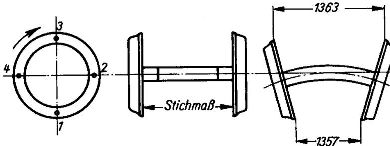
Bild 95. Vermessen einer entgleisten Achse
