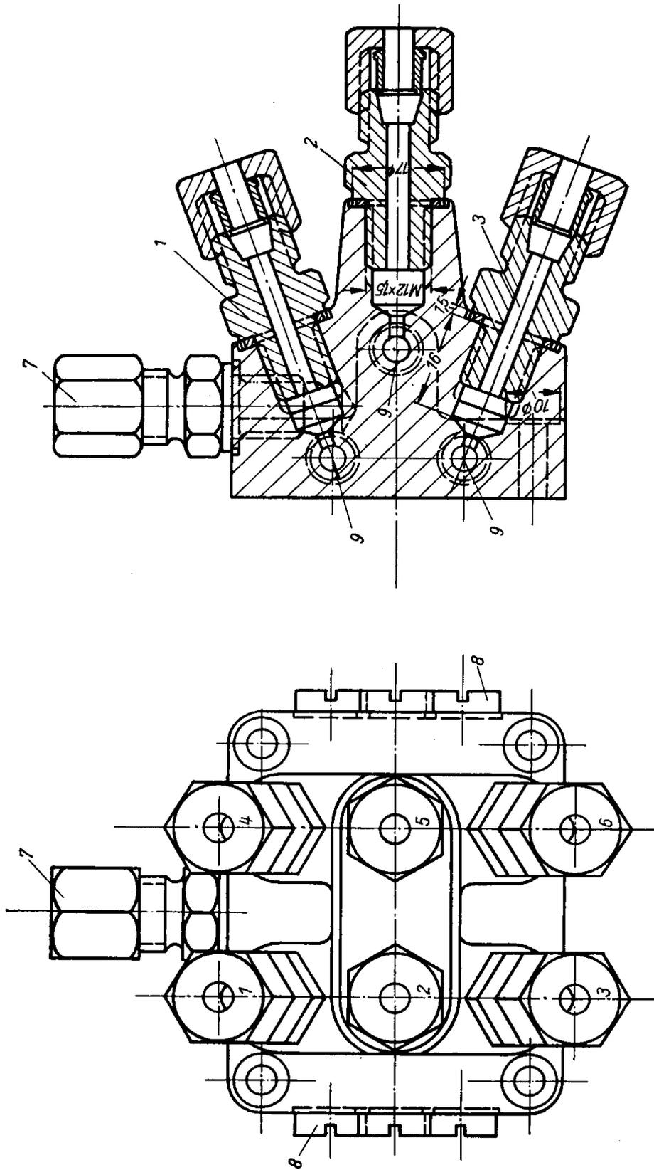
Bild 110. Schmierleitungsverteiler
