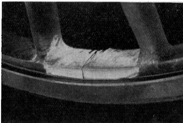
Bild 93. Geplatzter Unterreifen
