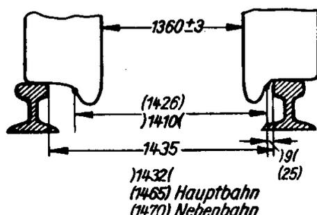
Bild 92. Lichte Maße zwischen zwei Rädern einer Achse
