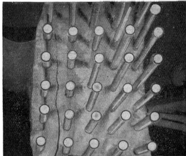
Bild 20. Ausgeglühte und gerissene
