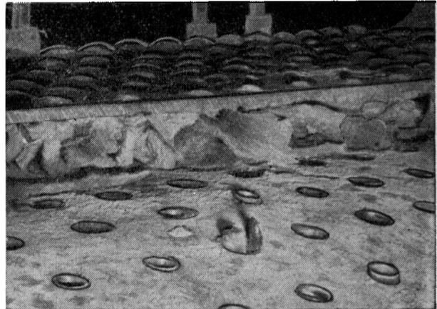
Bild 7. Völlig mit Kesselstein zugesetzte Feuerbüchse
