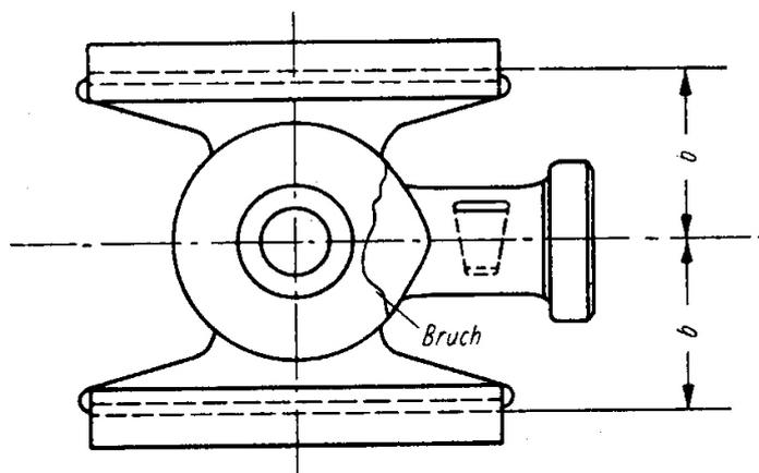
Bild 85. Bruch eines Kreuzkopfes mit doppelter Gleitbahn
