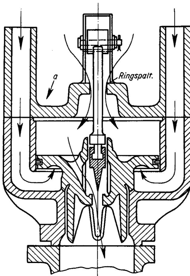
Bild 56. Ventilregler Bauart Wagner — Ältere Bauart —
