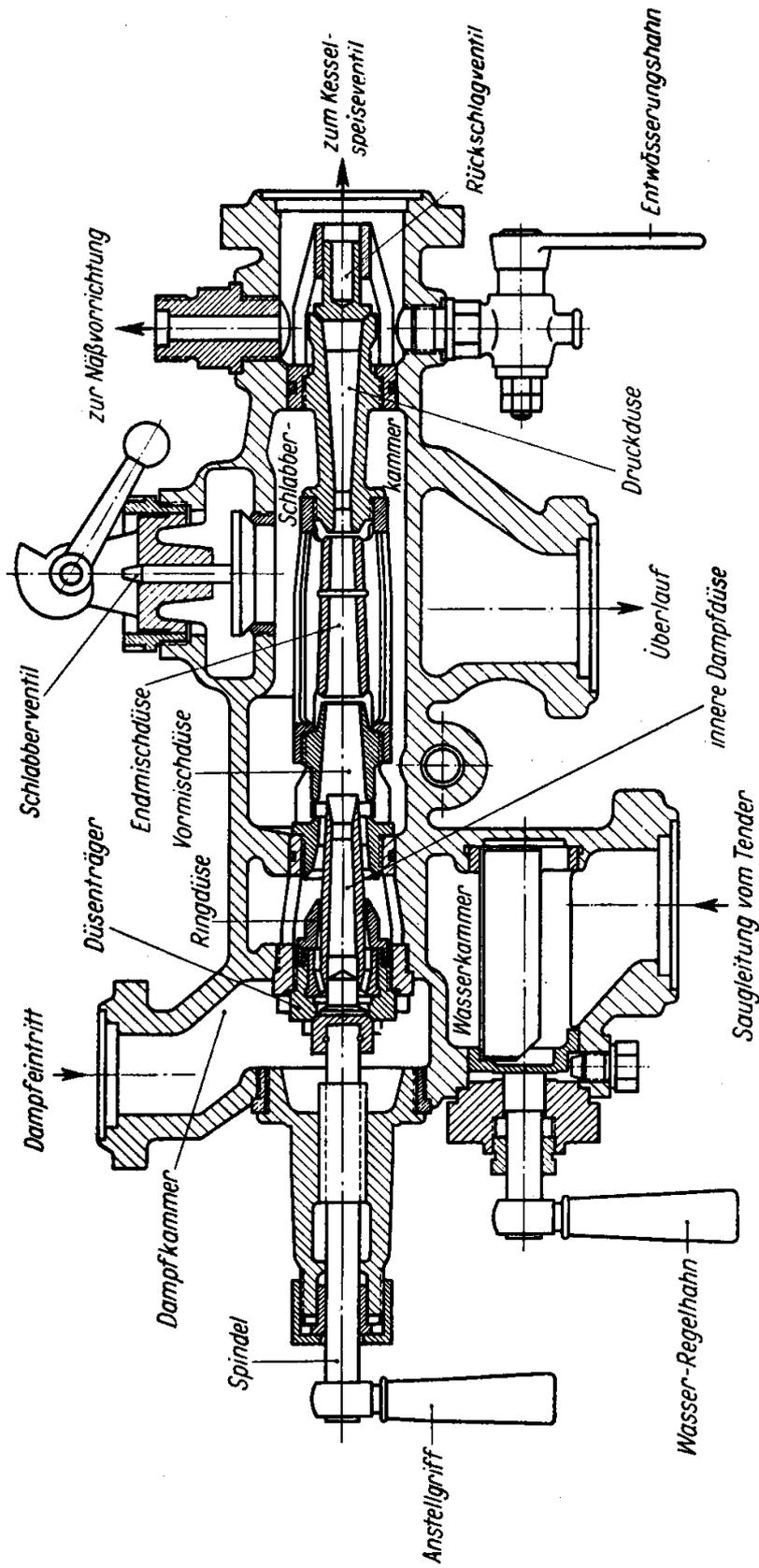
Bild 37. Dampfstrahlpumpe für 180 l/min — neuere Bauart —
